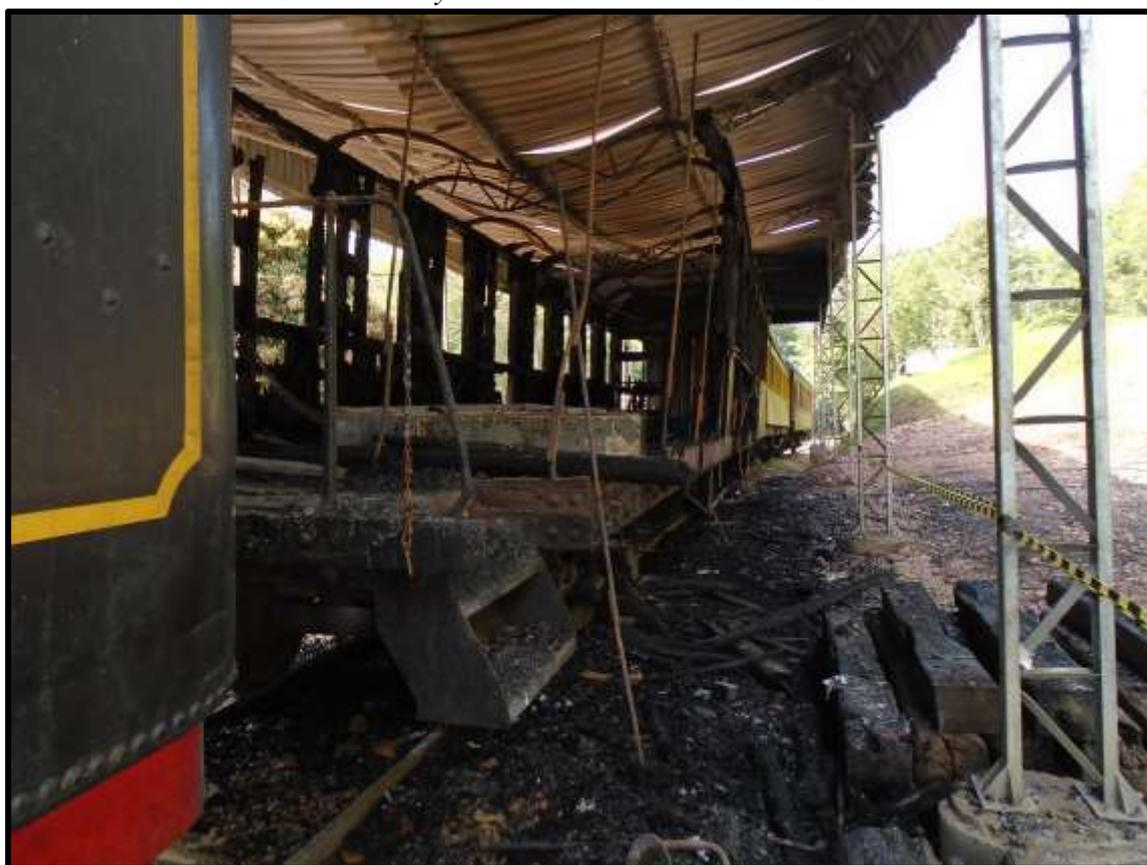
*Aspecto da lateral esquerda do carro P01, com destaque para o local onde iniciou o incêndio, na parte de dentro da primeira janela, ao lado de uma pilha de dormentes. Foto: Luiz Carlos Henkels em 18/08/2015.*
