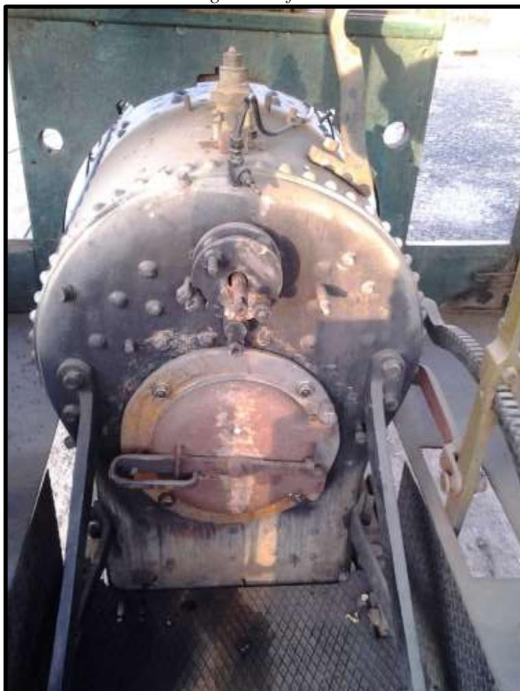
*Locomotiva 51 com o acabamento da fornalha já instalado.*
