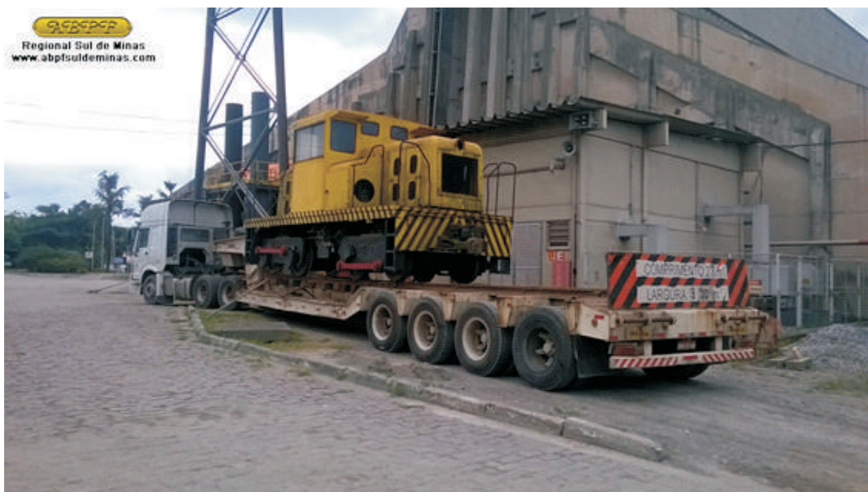
Processo de embarque da "Joana" e a mesma já carregada pronta para seguir viagem até Cruzeiro; foram necessários dois grandes guindastes para realizar o içamento das locomotivas e colocá-las sobre as carretas
