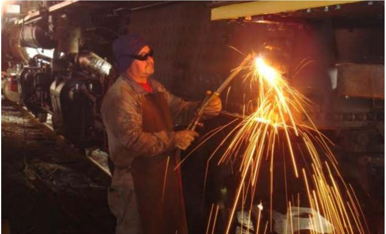
*Corte das cabeças dos estais do lado esquerdo na parte externa da Mallet*
