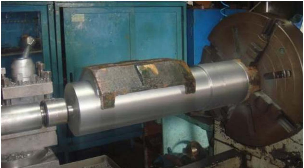
*Pino no diâmetro da eixo da roda guia traseira*
