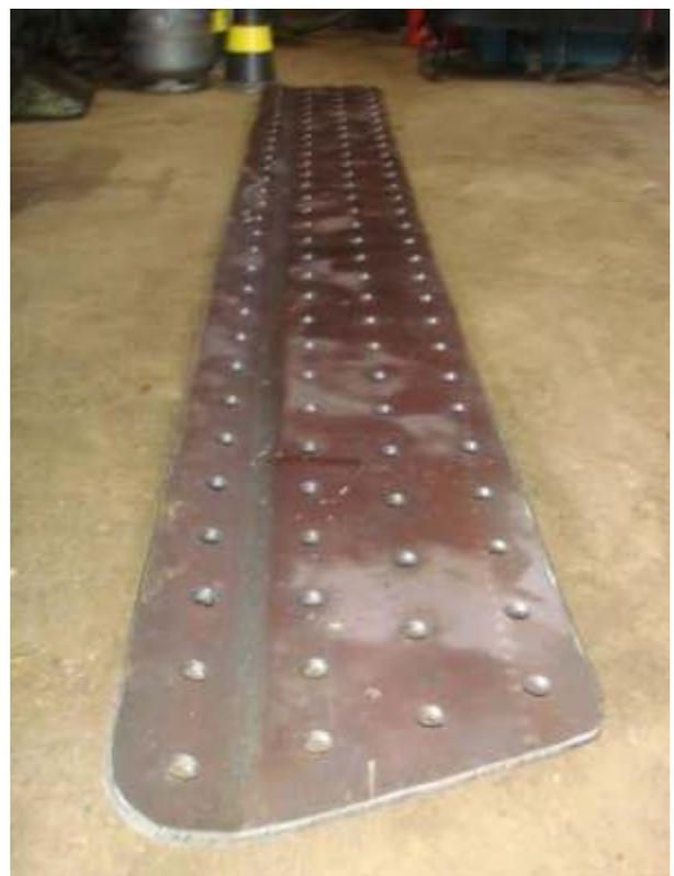
*Nova chapa da fornalha, lado direito pronta para instalação*
