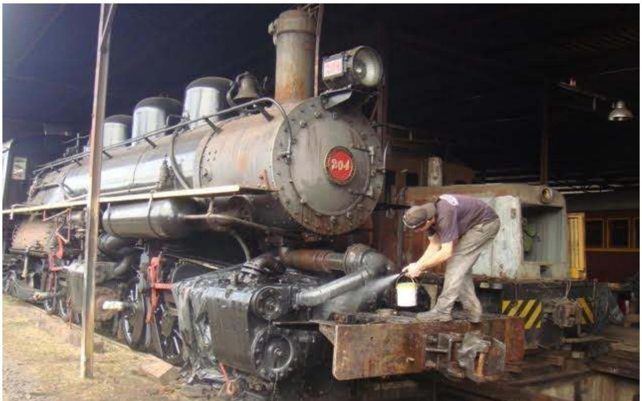
*Limpeza e lavagem para pintura na parte frontal para instalação da nova varanda*
