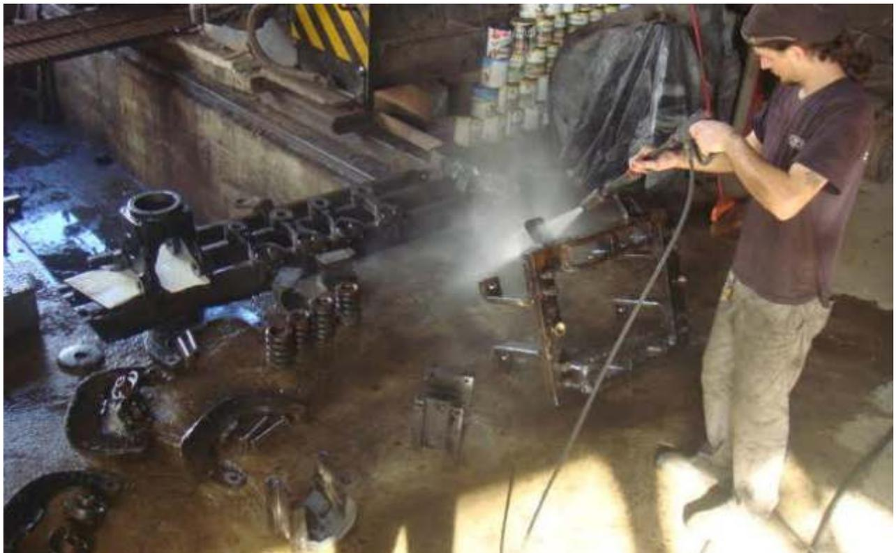
*Limpeza dos componentes da roda guia dianteira*
