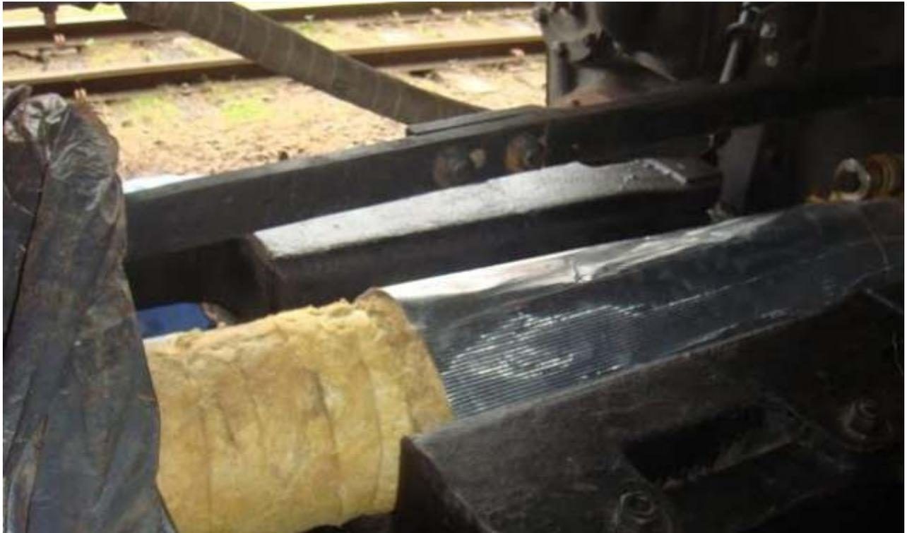
*Acabamento do isolamento térmico na tubulação de condução de vapor*
