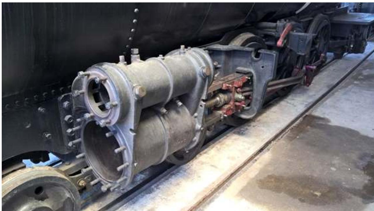
*Montagem e ajuste dos paralelos na locomotiva 327*
