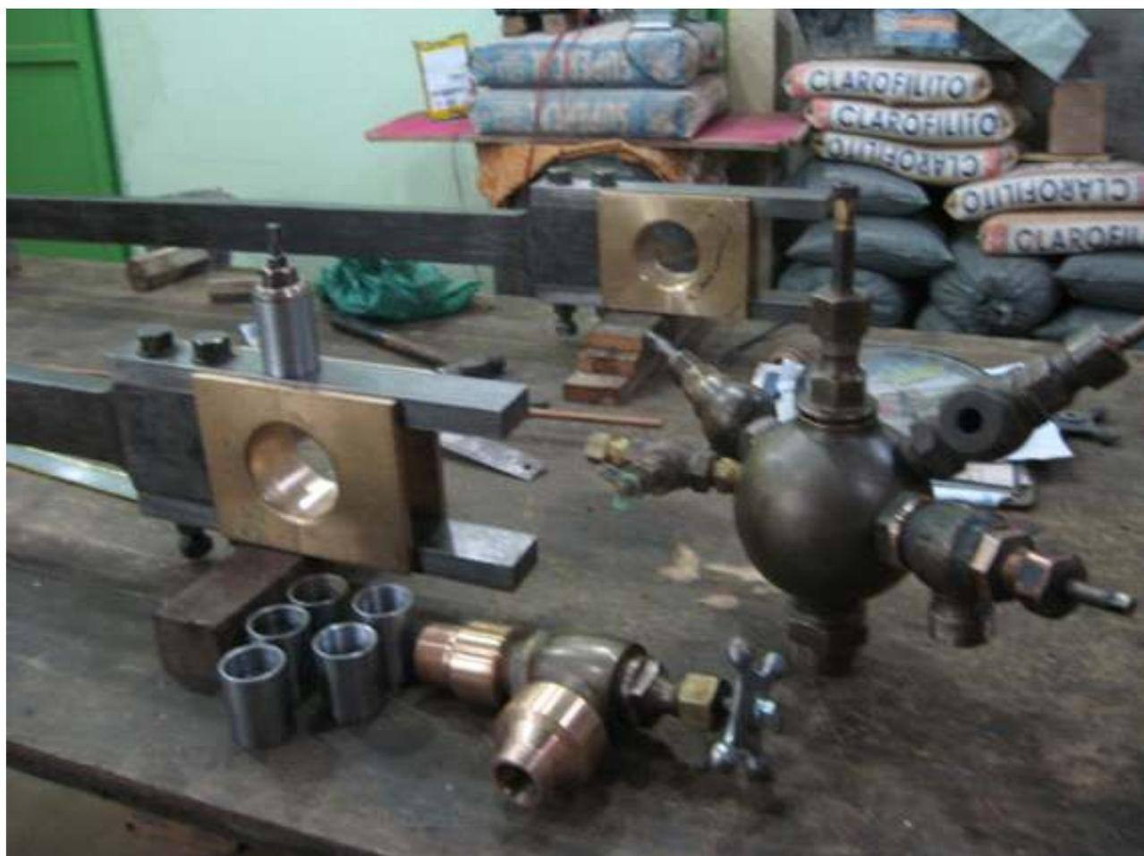
*As duas braçagens já com os estropos usinados e braçadeiras prontas para soldagem e fechamento da parte traseira*
