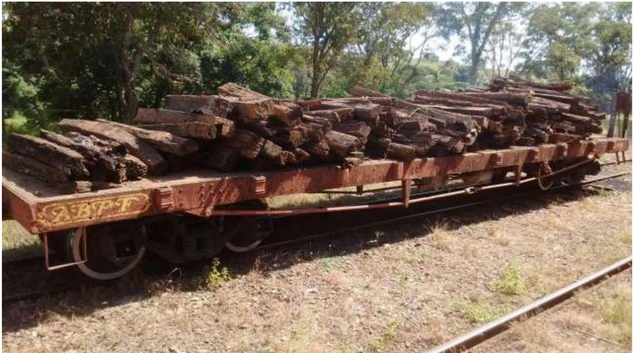
*Prancha carregada com dormentes de madeira que foram substituídos pelos de concreto*
