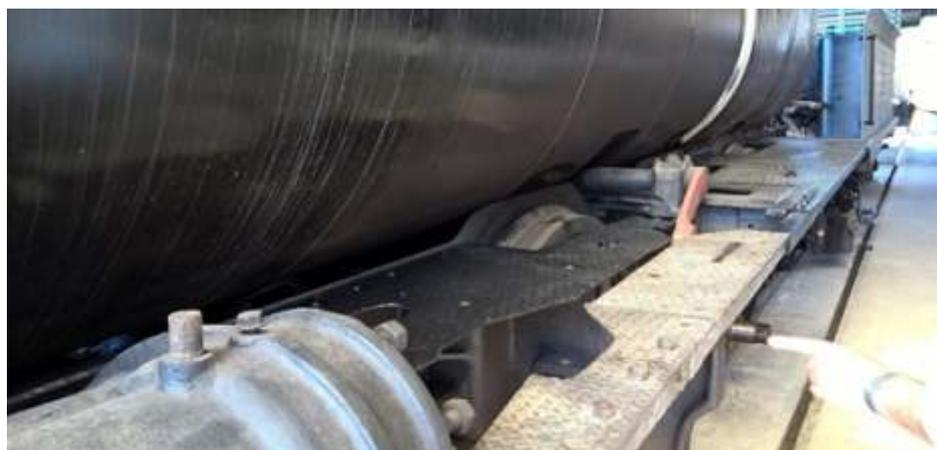
*Ensaio de instalação da chaparia antiderrapante nos passadiços da locomotiva 327*
