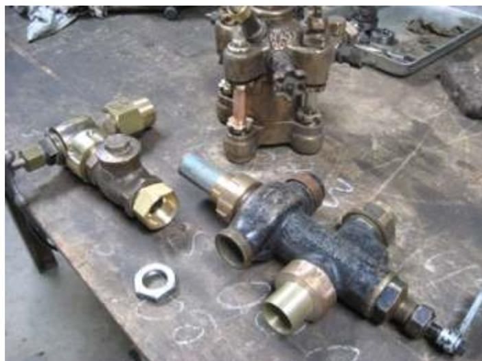
*Aparelho de óleo do compressor sendo limpo e restaurado para ser instalado nas próximas semanas, e confecção das últimas conexões do injetor do lado do maquinista*
