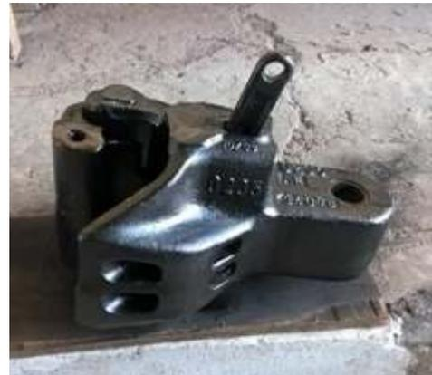
Um dos novos engates já pintado e pronto para ser instalado
