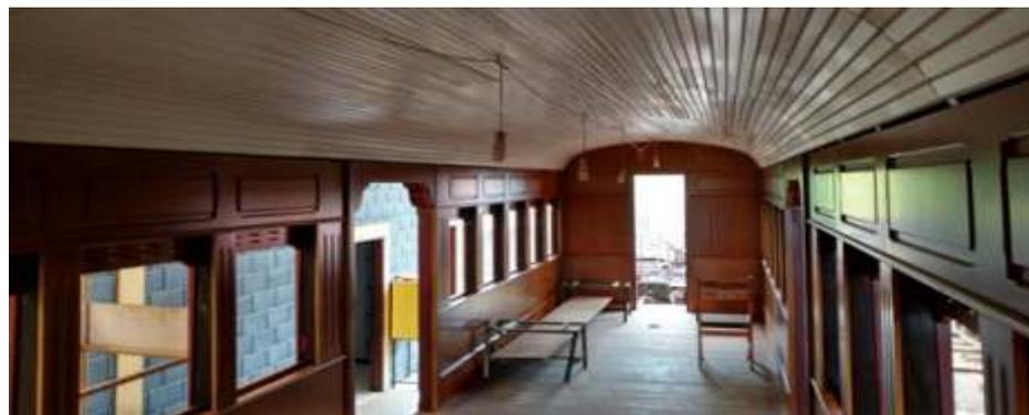
*Novo forro do BD-32 já instalado e pintado; nota-se que todo o novo revestimento interno do carro está praticamente concluído*
