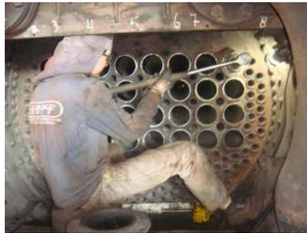
Os tubos sendo mandrilados no lado interno (fornalha)
