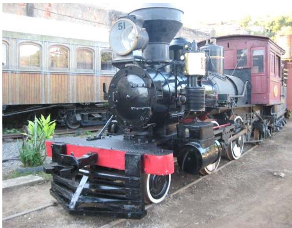
*A bomba de ar instalada no suporte soldado no corpo cilíndrico da locomotiva 51*
