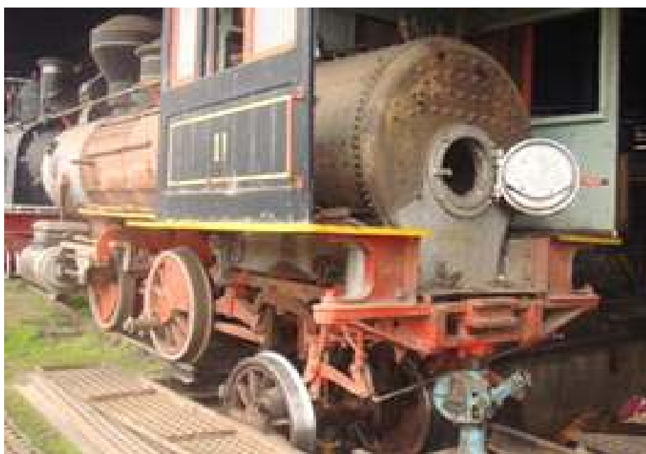
Recolocação do rodeiro nº 03 na locomotiva Mogul nº 11
