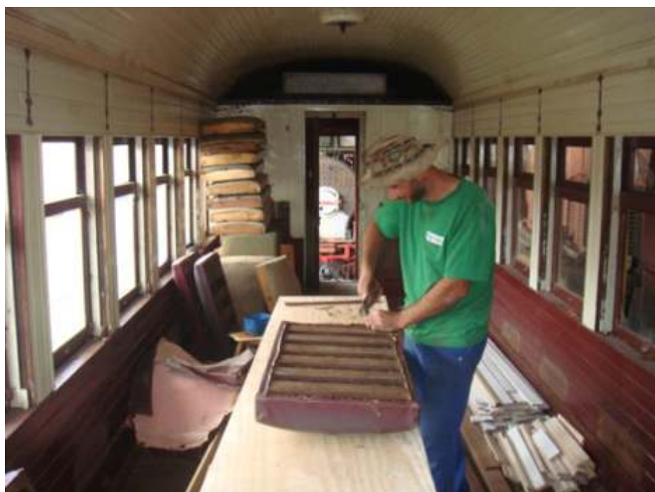
Trabalhos de retirada do revestimento de encosto e poltronas por nosso amigo Cid Turatti da ABPF –Paraná
