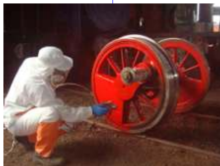
Usinagem e pintura do rodeiro e pintura do longeirão da locomotiva Mogul nº 11, da ABPF-PR
