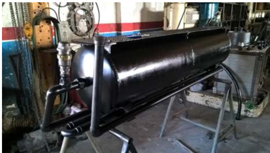
Um dos reservatórios principais de ar após a conclusão dos trabalhos e pronto para ser instalado na locomotiva
