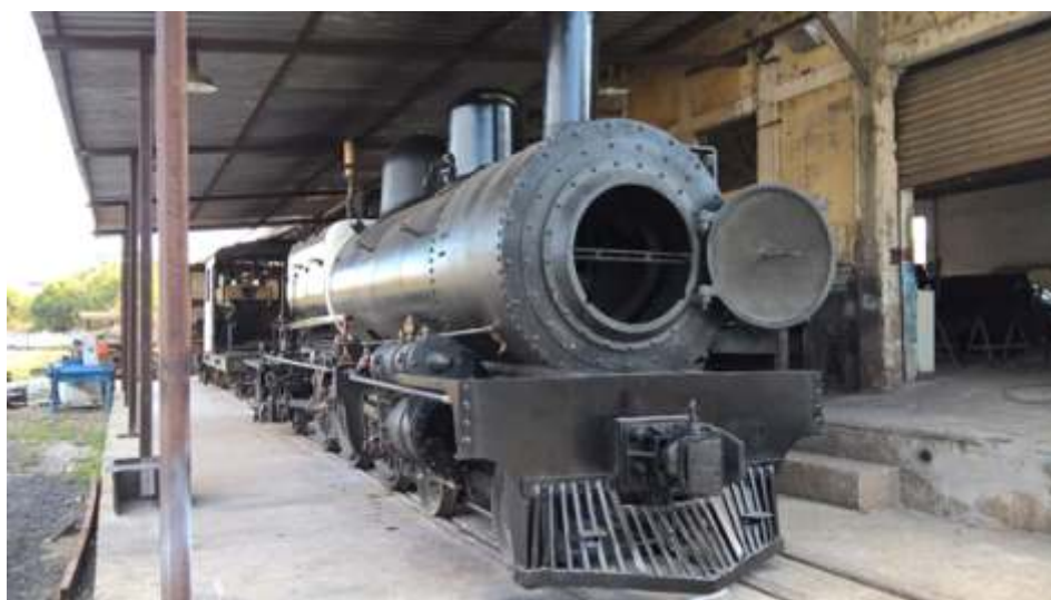
A locomotiva 327 já com o areeiro principal e a capa do domo de vapor instalados além de ter recebido uma pintura geral
