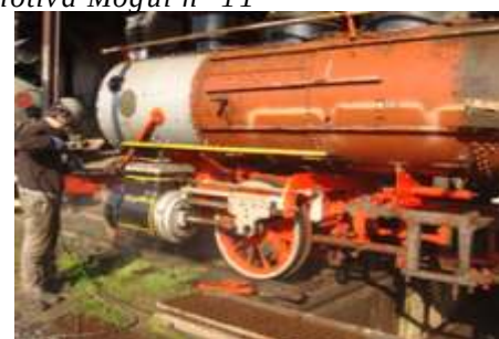
Limpeza da maquina com jato de alta pressão
