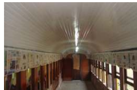
O carro C-16 com a pintura antiga removida, com o nivelador de fundo e com novo forro pintado
