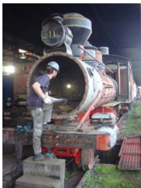
Colocação de novos tubos
