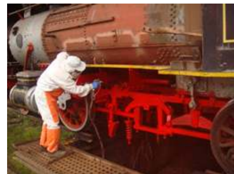
Usinagem e pintura do rodeiro e pintura do longeirão da locomotiva Mogul nº 11, da ABPF-PR
