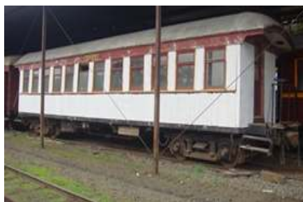
O carro C-16 com a pintura antiga removida, com o nivelador de fundo e com novo forro pintado
