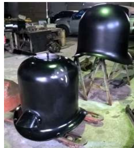
O areeiro principal e a capa do domo de vapor já receberam a nova pintura e já foram instalados na locomotiva
