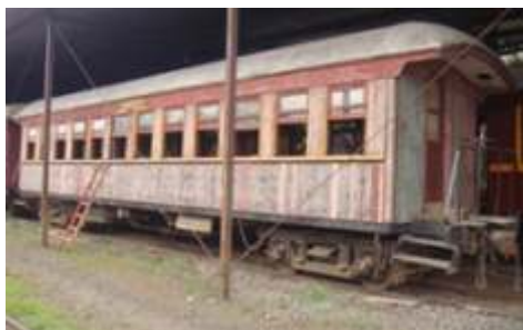
O carro C-16 com a pintura antiga removida, com o nivelador de fundo e com novo forro pintado
