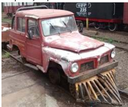
O início da funilaria após lixamento e recebendo correção com massa
