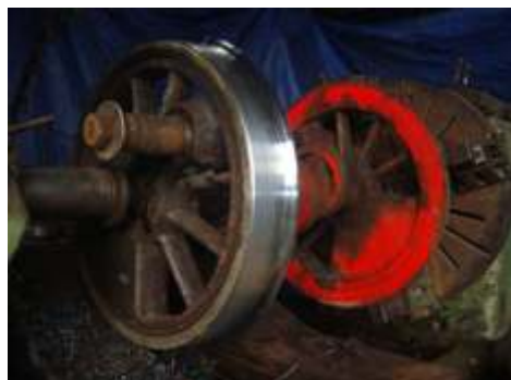
Usinagem e pintura do rodeiro e pintura do longeirão da locomotiva Mogul nº 11, da ABPF-PR
