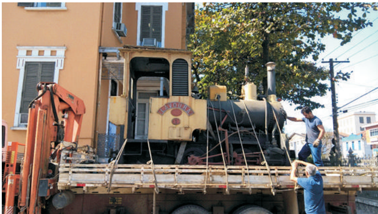
Nossos colaboradores concluindo a amarração da locomotiva sobre o caminhão
