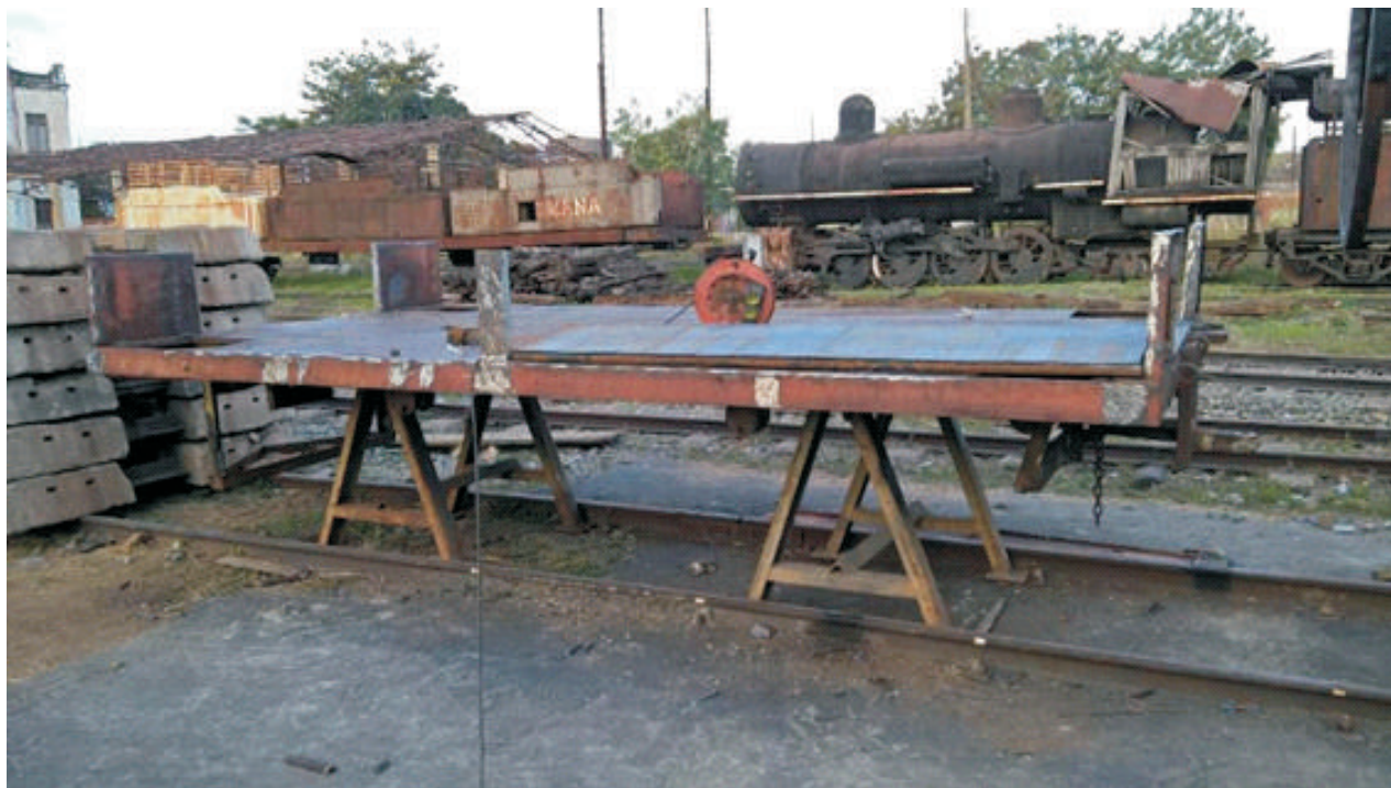
Vagonete AS-70 com a manutenção já iniciada nas oficinas de Cruzeiro.
