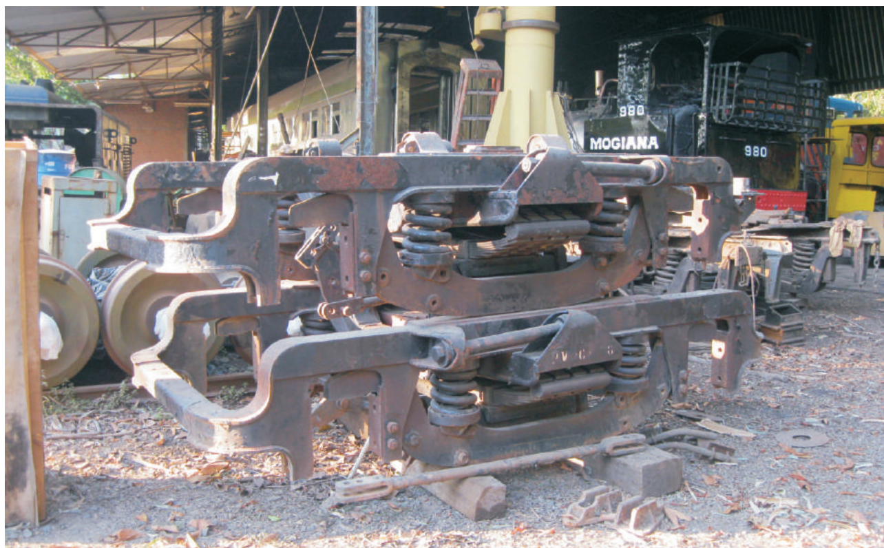
Truques sendo preparados para receber novos rodeiros!
