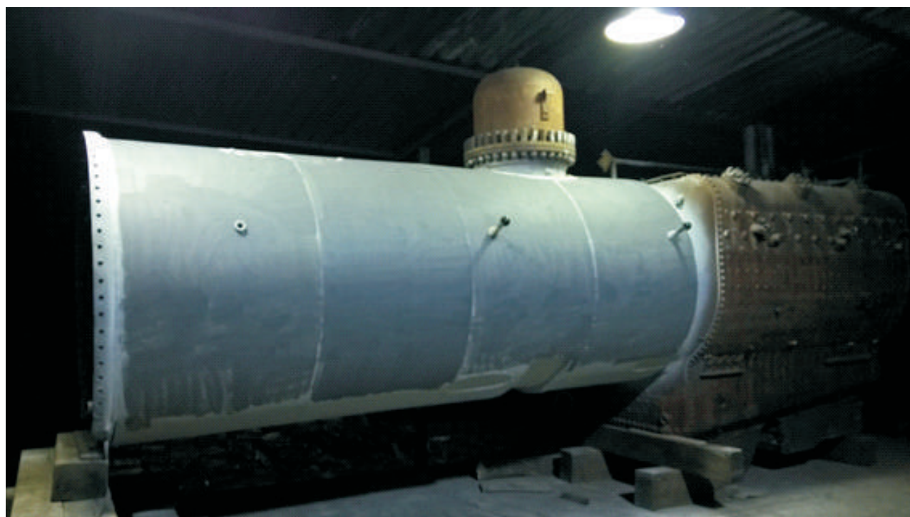
Revestimento do corpo da caldeira da locomotiva 327 já com primer aplicado
