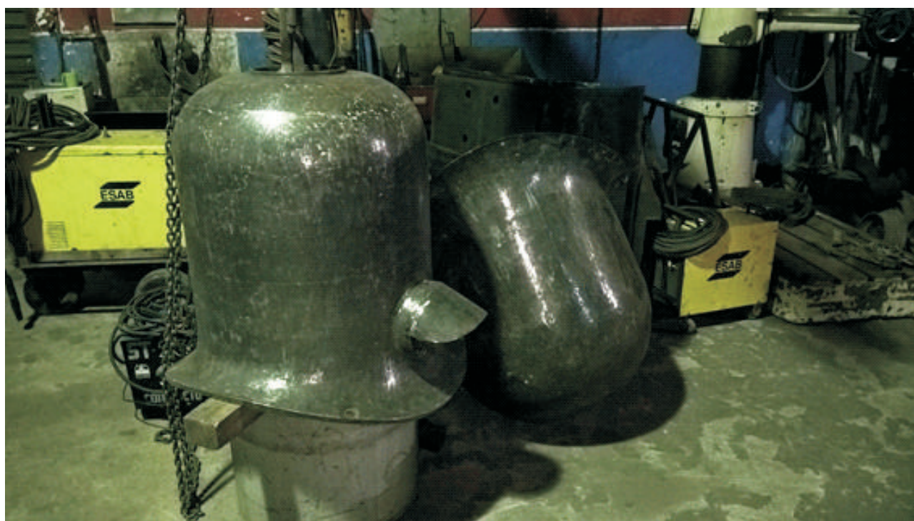
O areeiro e a capota do domo de vapor da 327 no metal cru, já preparados para receber a base para a nova pintura ser aplicada
