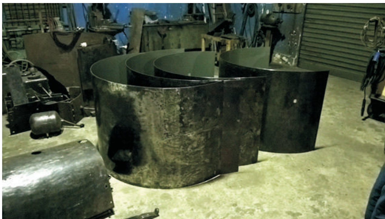
Chapas já moldadas para confecção do revestimento da caldeira da locomotiva 327.
