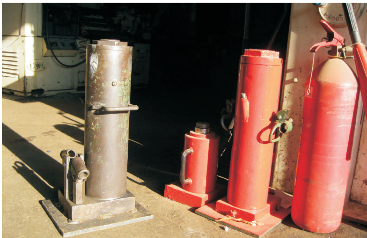
Macacos recebidos pelo DNIT e já reparados
