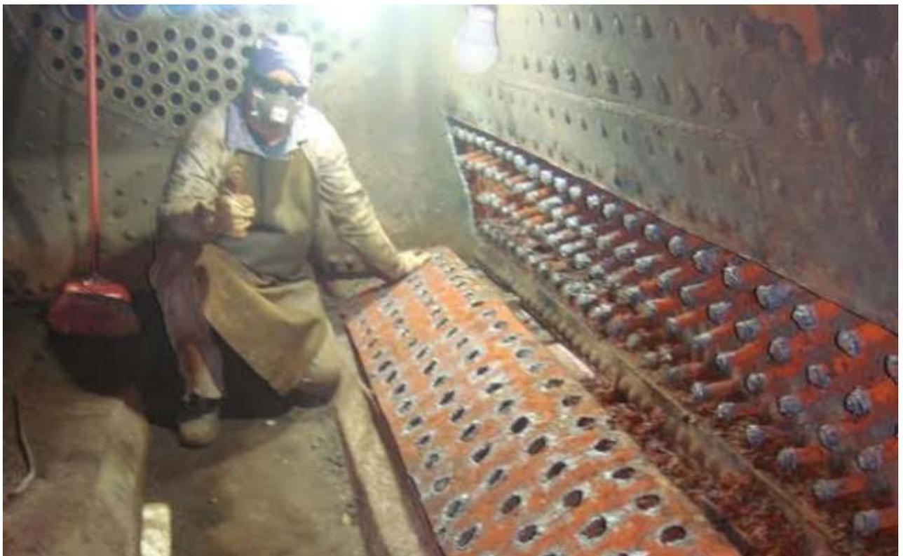
*Retirada da chapa interna do lado direito da fornalha da locomotiva*
