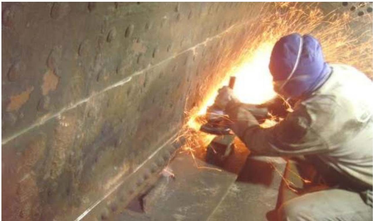
*Corte da chapa interna destinada ao lado esquerdo da fornalha da locomotiva Mallet nº 204*
