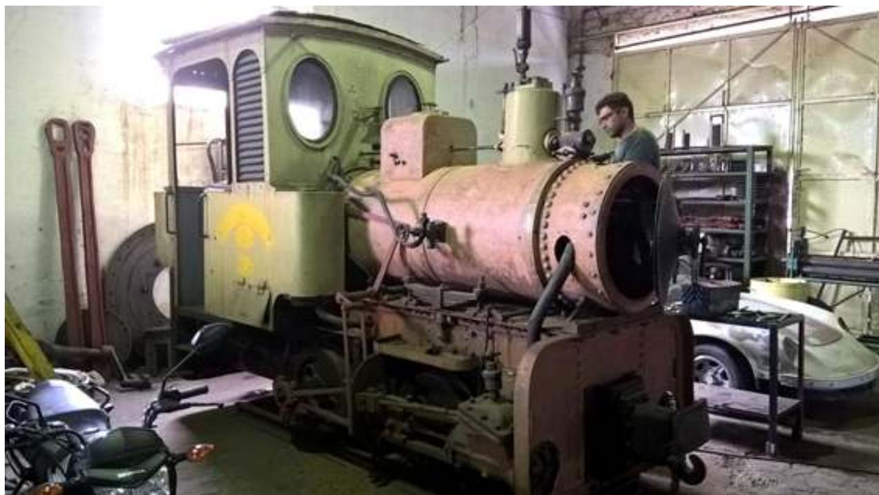
*A locomotiva já foi parcialmente desmontada e toda a sujeira, ferrugem e pintura antiga estão sendo removidas*
