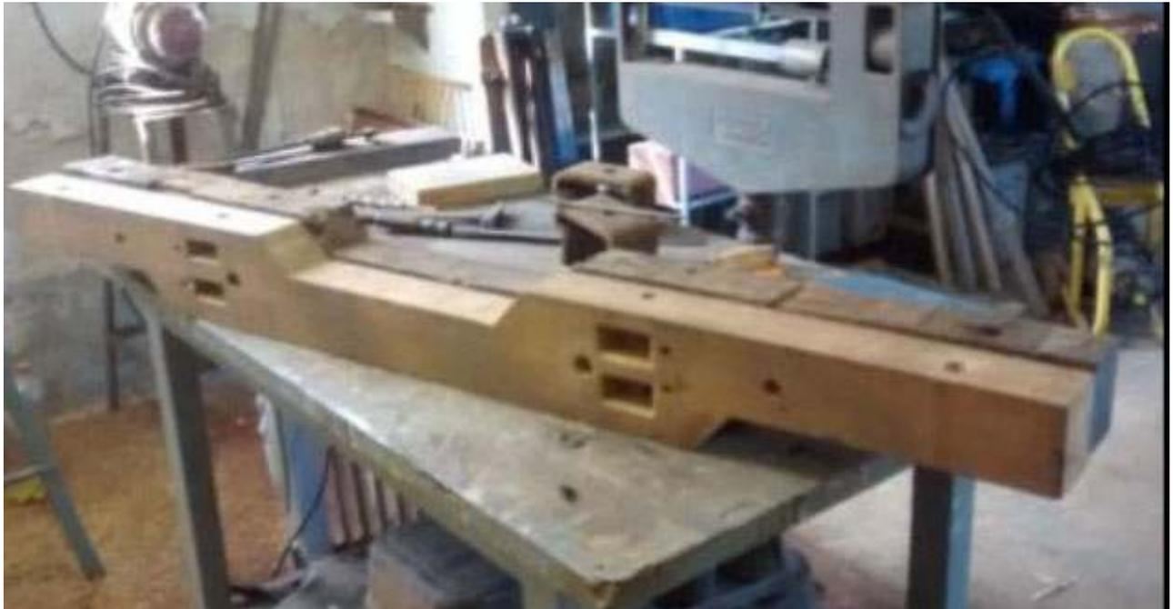
*Travessa que foi instalada no carro C-05 substituindo a danificada*
