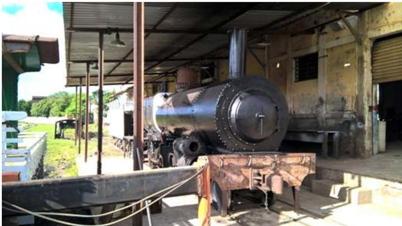
*Colocação do novo revestimento na área da fomalha da locomotiva 327*
