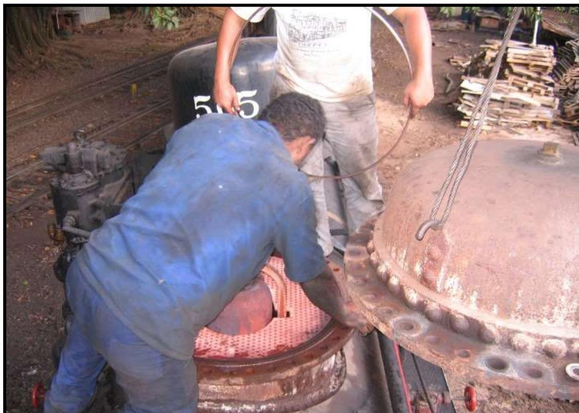
*Fechamento do domo da locomotiva 505 após esmerilhamento de válvula para teste hidrostático.
