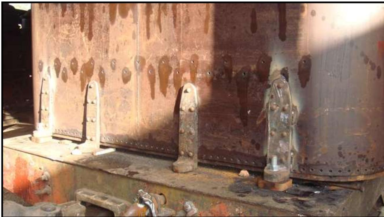
*Acima: Peças de fixação originais do t tender da Mallet nº 204 instaladas no novo t tender.*
