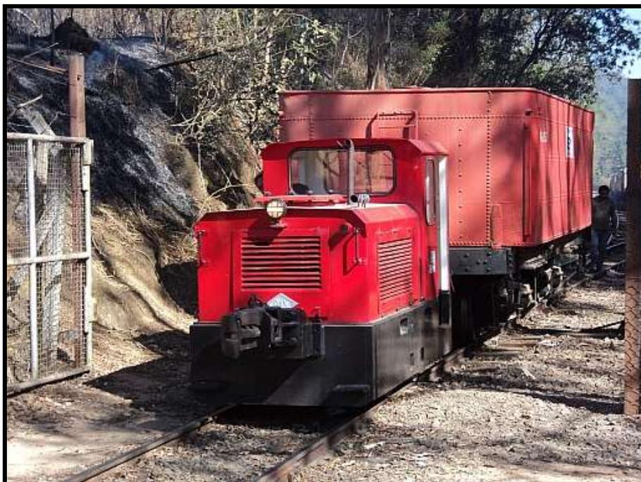
*Acima: Locomotiva O&K rebocando tender equipado com bomba d'água e utilizado pela brigada de incêndio da VFCJ.*
