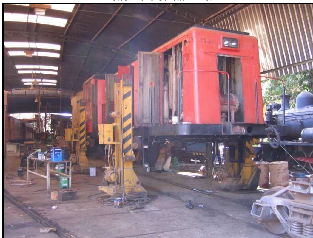
Acima: Truques da locomotiva GE 3136 prestes a serem recolocados na locomotiva. Abaixo: Locomotiva 3136 suspensa por macacos no aguardo da instalação dos truques. Fotos: Hélio Gazetta Filho.
