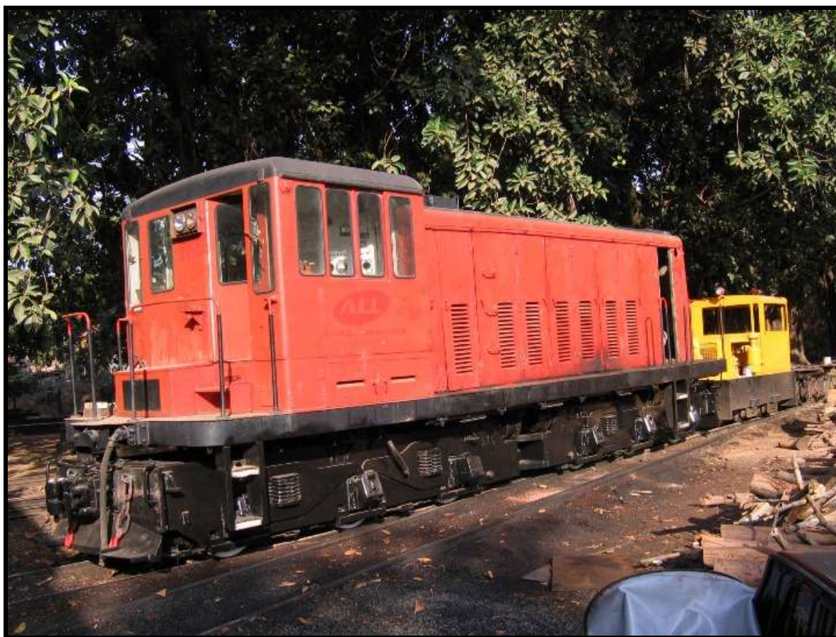
Locomotiva 3136 já com os truques reinstalados. Foto: Hélio Gazetta Filho.
