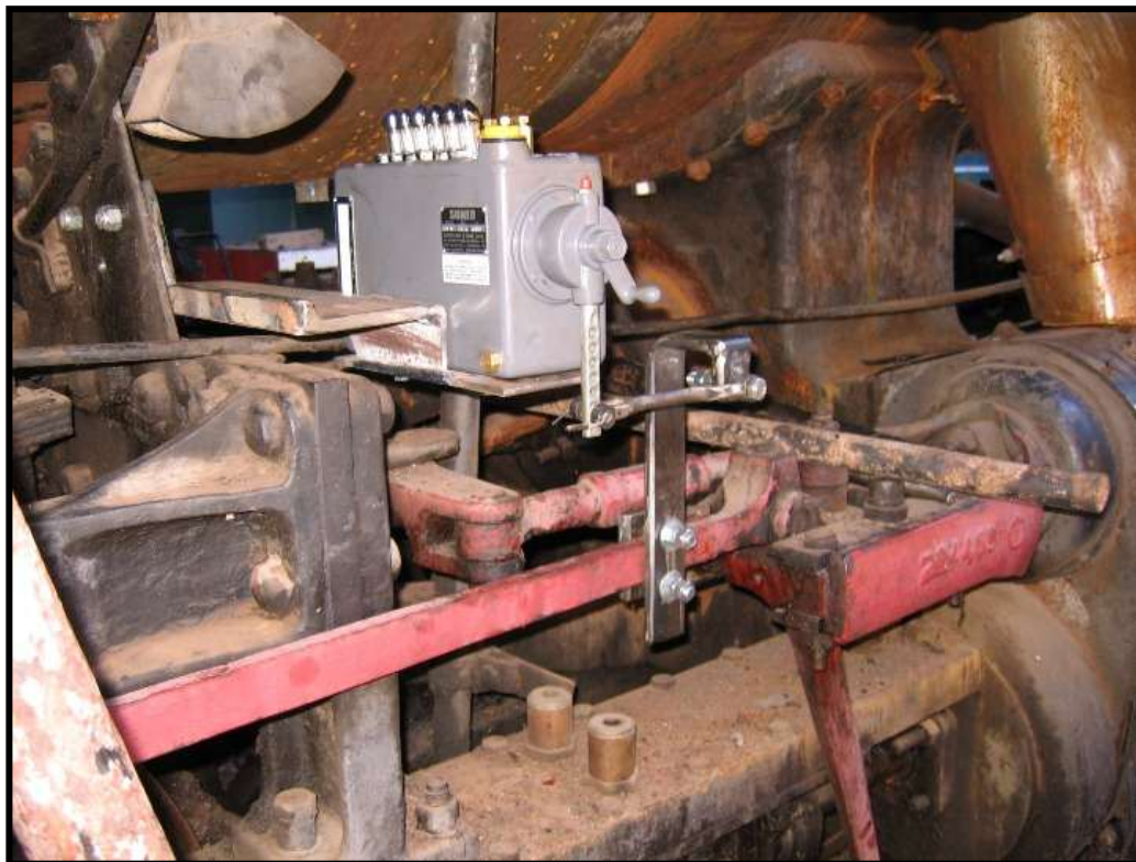
Acima: Novo detentor de fagulhas instalado na locomotiva 338. Abaixo: Nova bomba de lubrificação de seis bicos instalada na locomotiva 338. Fotos: Hélio Gazetta Filho.
