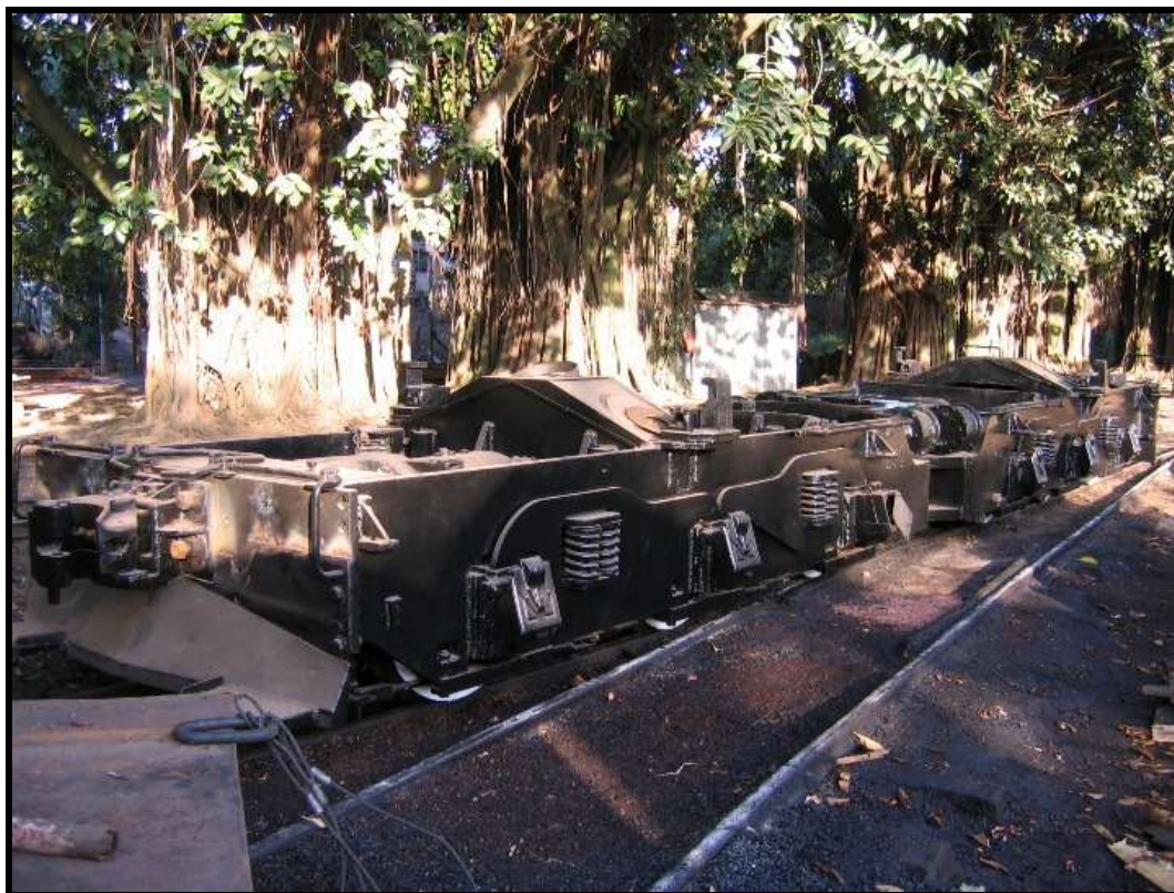
Acima: Truques da locomotiva GE 3136 prestes a serem recolocados na locomotiva. Abaixo: Locomotiva 3136 suspensa por macacos no aguardo da instalação dos truques. Fotos: Hélio Gazetta Filho.
