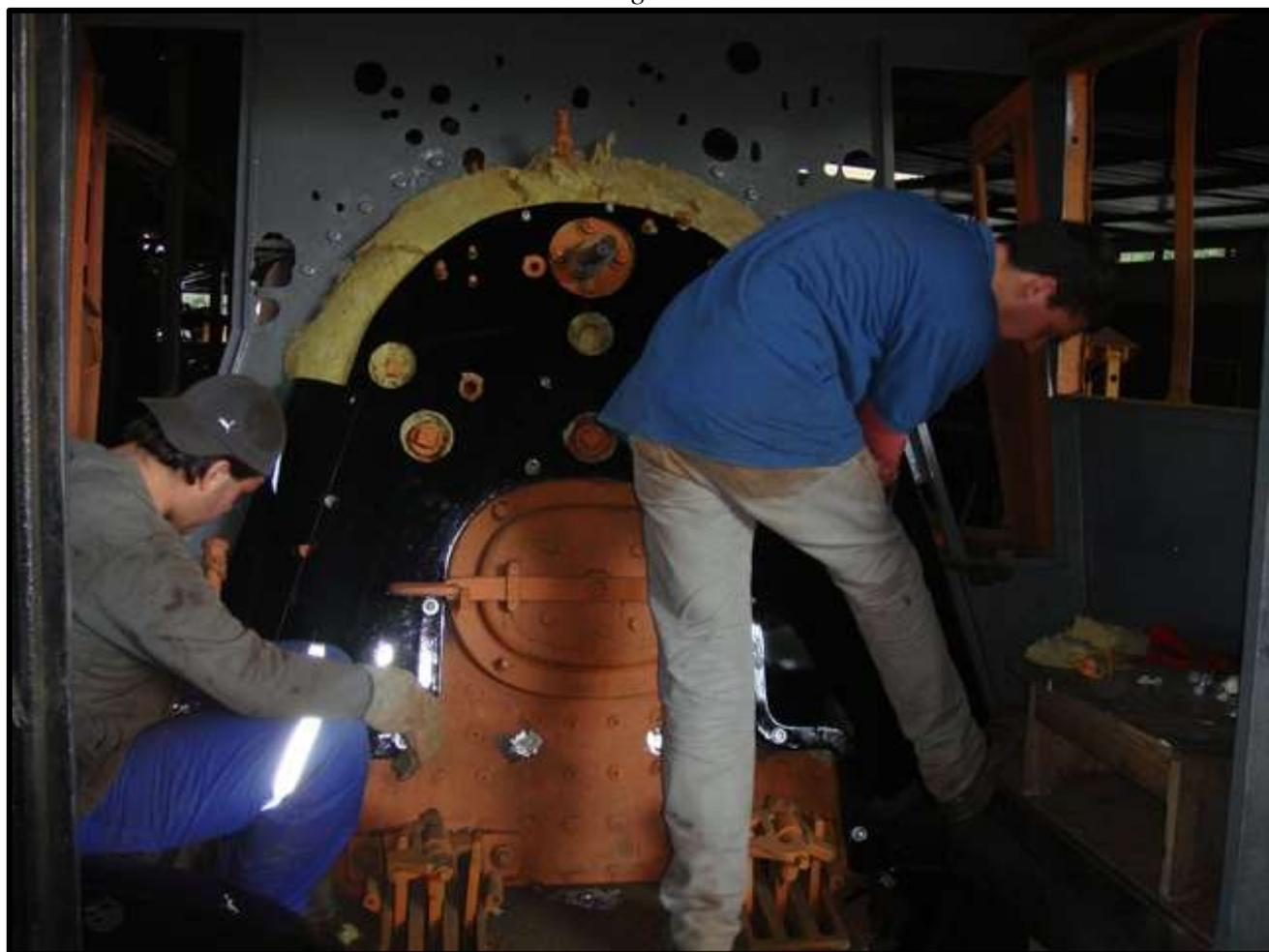
*Colocação de lã de rocha e montagem das chapas na 204.*
