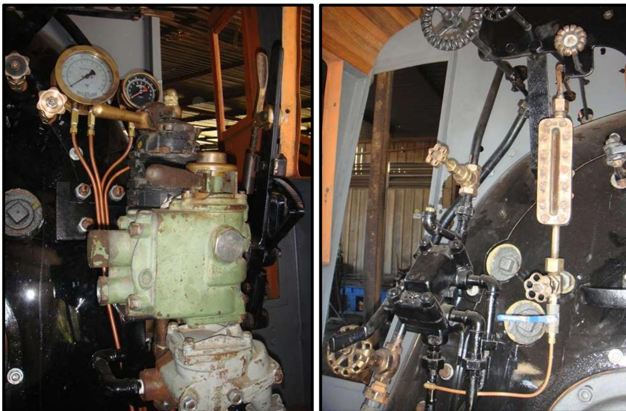
*Em sentido horário: Aparelho de freio automático, visor d'água e manômetros de ar na cabine da locomotiva articulada 204.*
