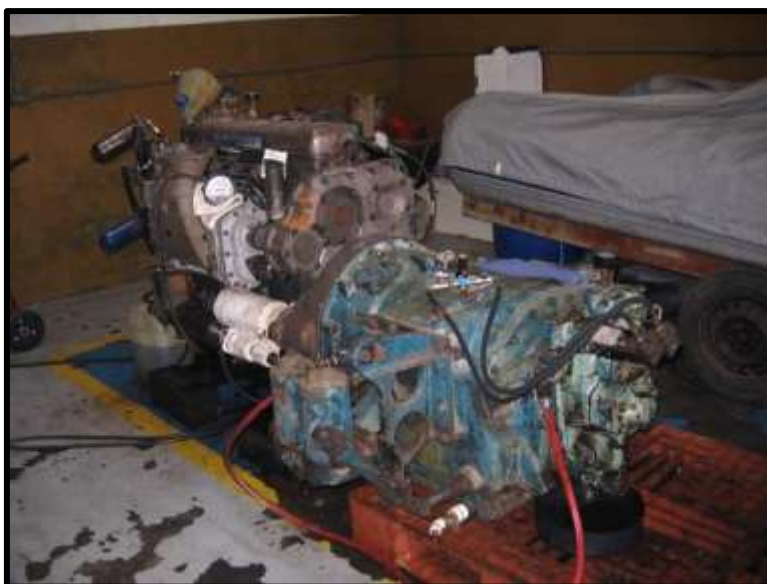
Motor Detroit acoplado à transmissão (equipamento azul) durante testes. Fotos: Hélio Gazetta Filho.
