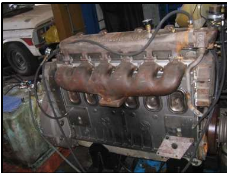
Motor Detroit acoplado à transmissão (equipamento azul) durante testes. Fotos: Hélio Gazetta Filho.
