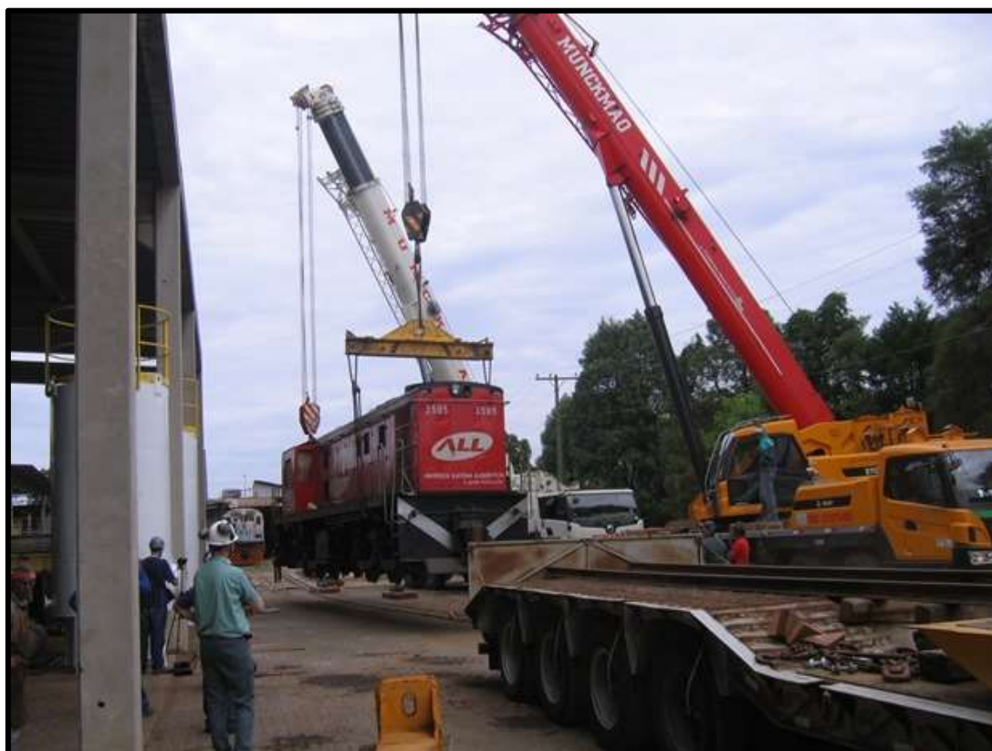
Chegada da locomotiva Alco RSD-8 a Paulínia. Içamento da locomotiva para colocá-la na carreta de transporte. Fotos: Hélio Gazetta Filho.
