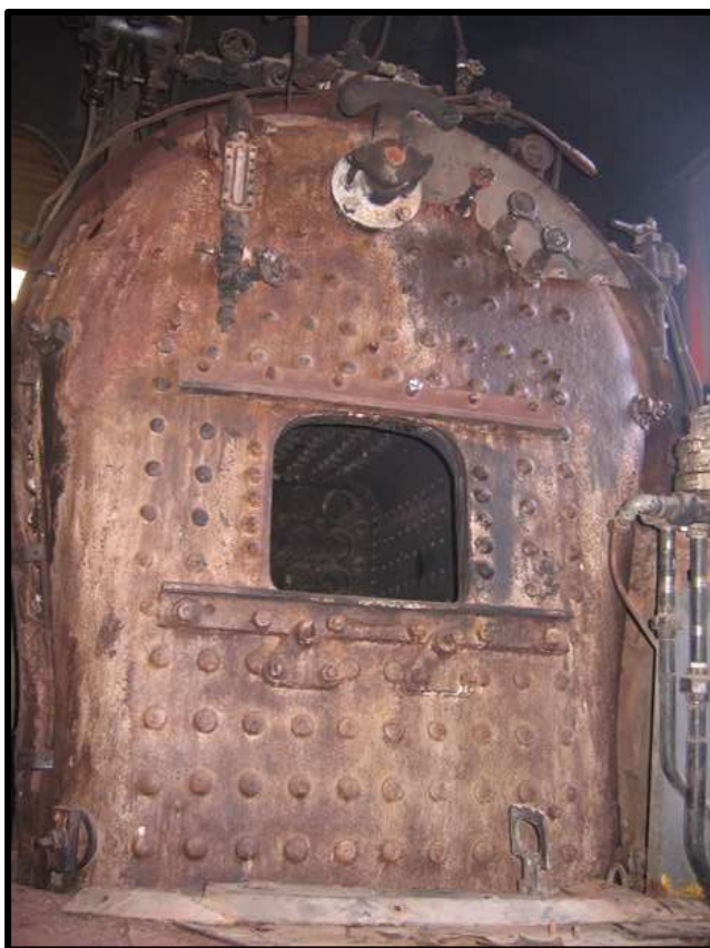
Acima: Fornalha da locomotiva 50 em restauração. Abaixo: Restauração do tênder da locomotiva 9. Fotos: Hélio Gazetta Filho.
