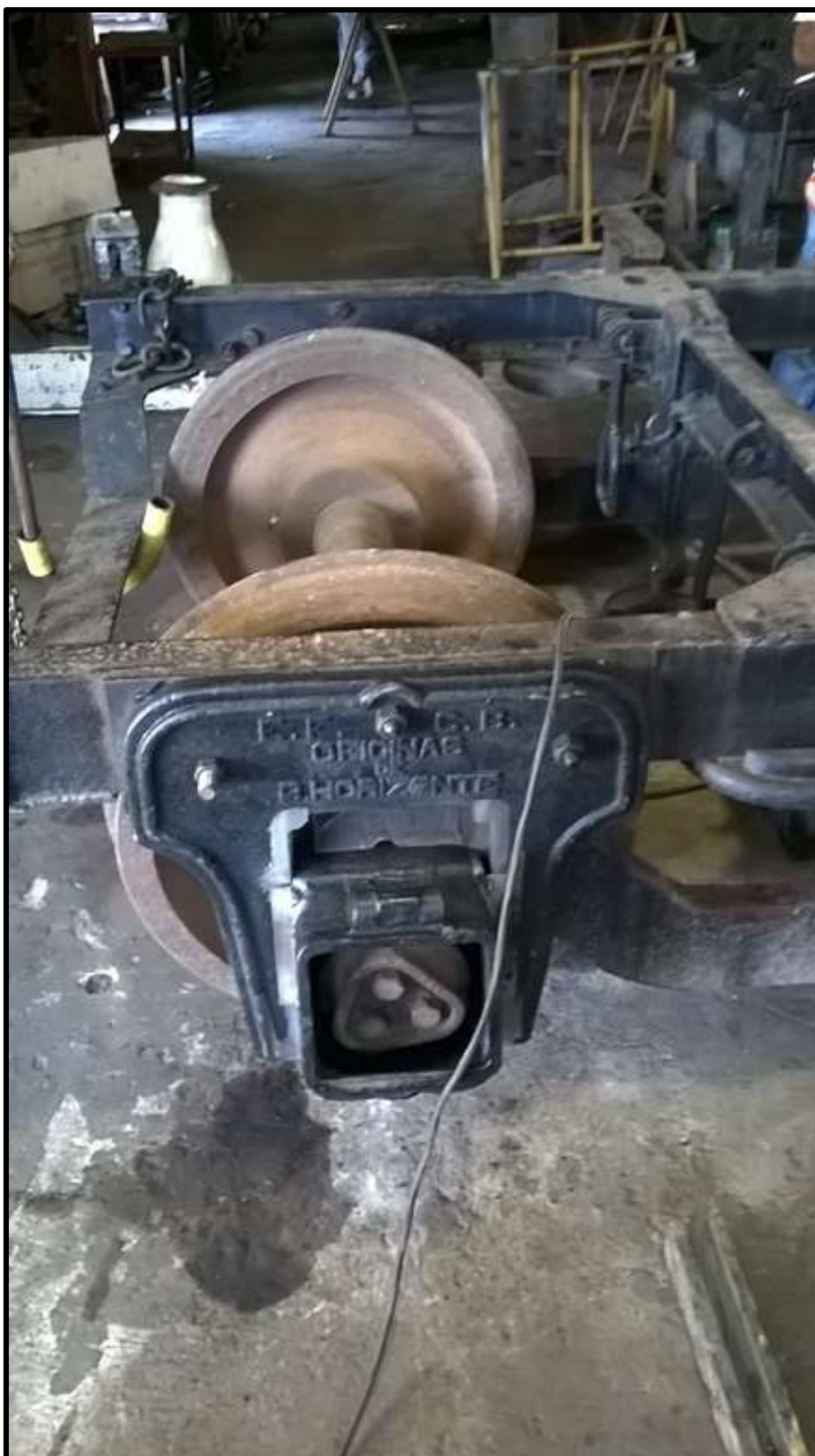
Detalhe da adaptação de eixo com rolamento ao truque de carro da EFCB.
