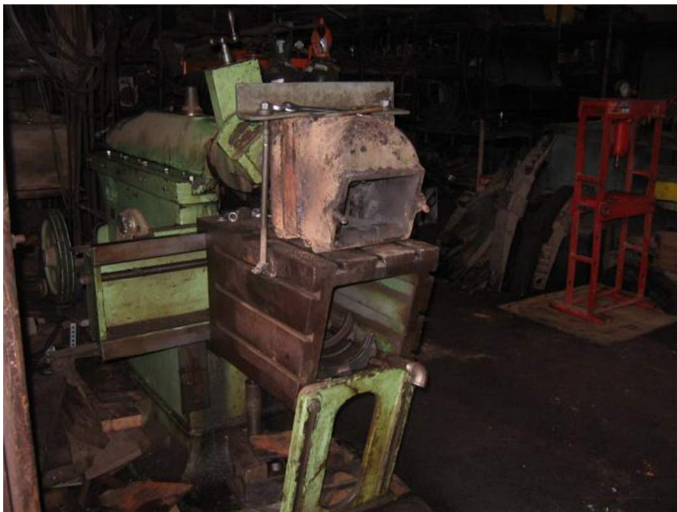
Caixa de truque de carro de passageiros sendo usinada para a adaptação de rolamento. Esse procedimento elimina a “caixa de graxa” com lubrificação por meio de “bonecas de estopa”, tornando a operação mais eficiente e preservando o material rodante
