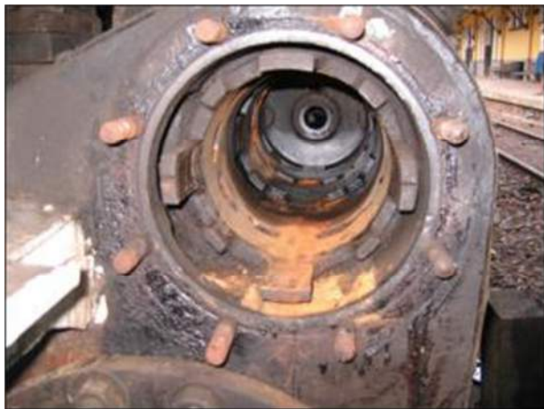
Os êmbolos do cilindro da locomotiva nº 505 foram retirado para a usinagem de novos
