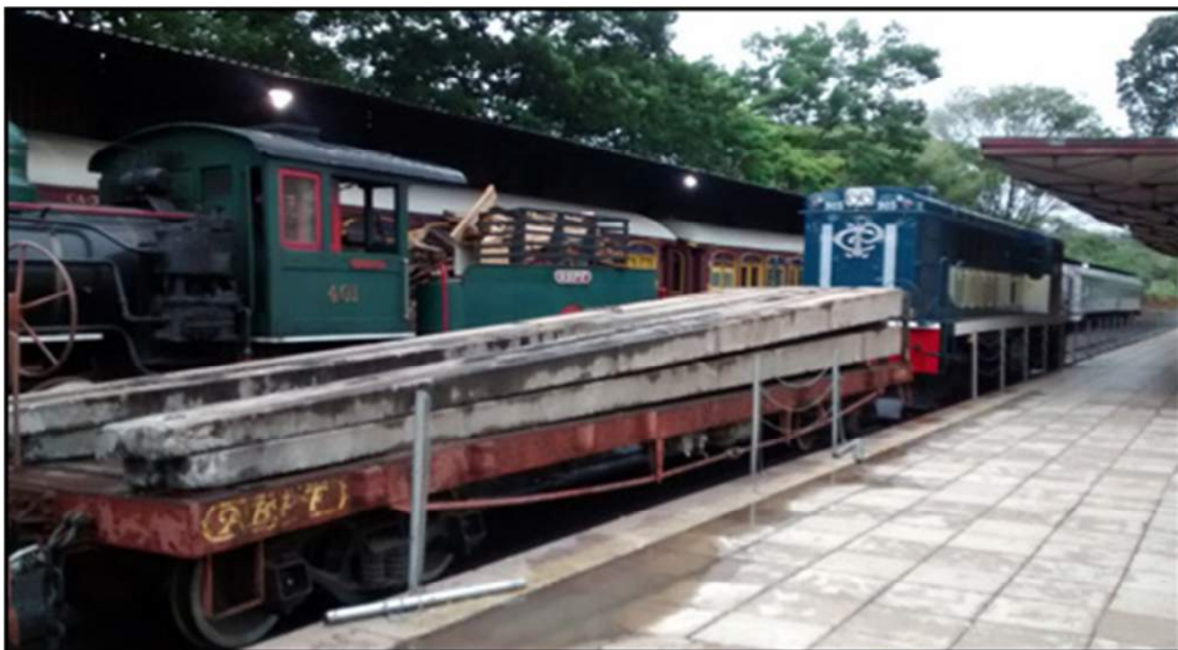
Os postes de concreto do antigo VLT de Campinas foram transportados em uma prancha de Anhumas até Tanquinho
