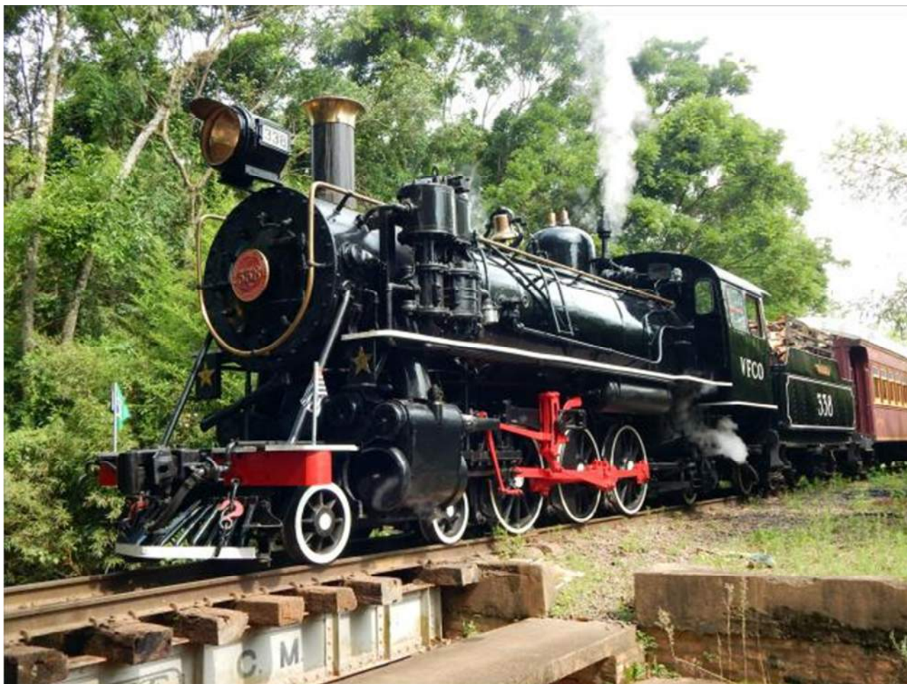
Raridades: a nº 338 (bitola métrica) e a nº 353 (bitola de 1.60 m) são os dois únicos exemplares existentes no mundo de locomotivas “Pacific” com três cilindros.
