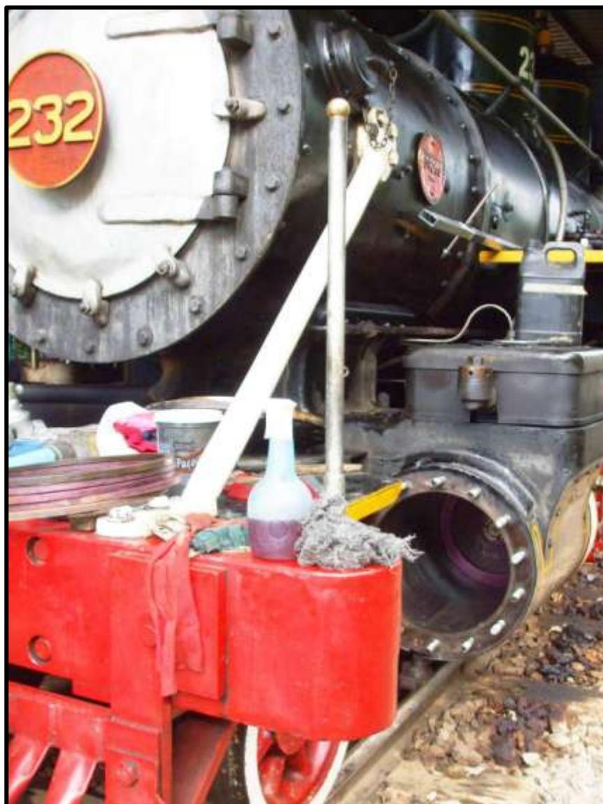
*Locomotiva 232 já com o novo êmbolo da esquerda recolocado. O êmbolo da direita também será trocado, após o que se fará a nova regulagem das braçagens.*
