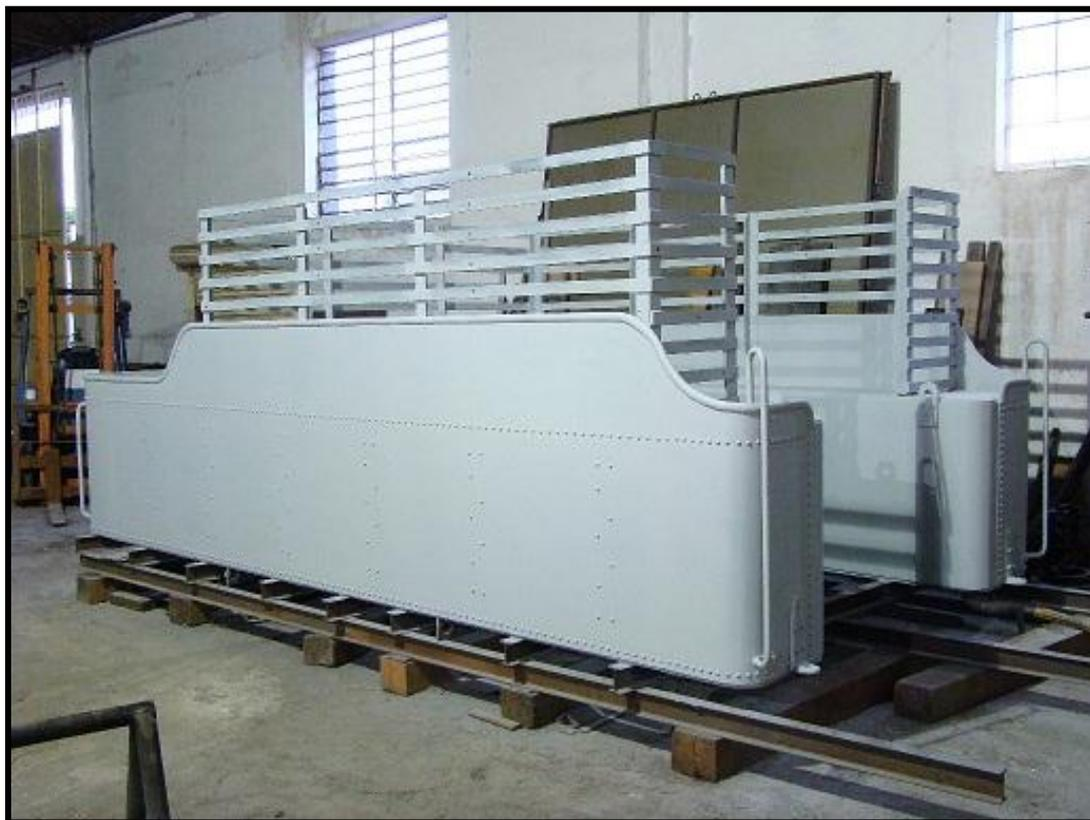
*Tênder da locomotiva 725 construído nas Oficinas de Cruzeiro da ABPF - Sul de Minas.
