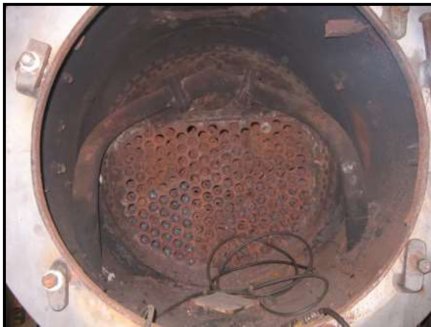
Acima: Caixa de fumaça da locomotiva 9 da EFA que está recebendo novos tubos na caldeira. Abaixo: Note embaixo da caixa de fumaça o terceiro cilindro recém fechado da locomotiva 338. Fotos: Hélio Gazetta Filho.
