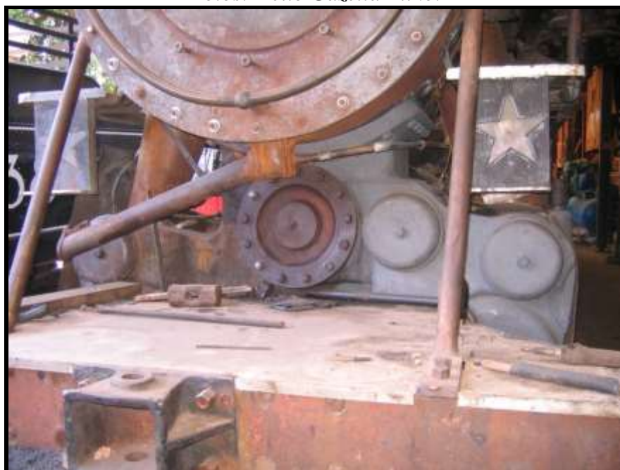
Acima: Caixa de fumaça da locomotiva 9 da EFA que está recebendo novos tubos na caldeira. Abaixo: Note embaixo da caixa de fumaça o terceiro cilindro recém fechado da locomotiva 338. Fotos: Hélio Gazetta Filho.
