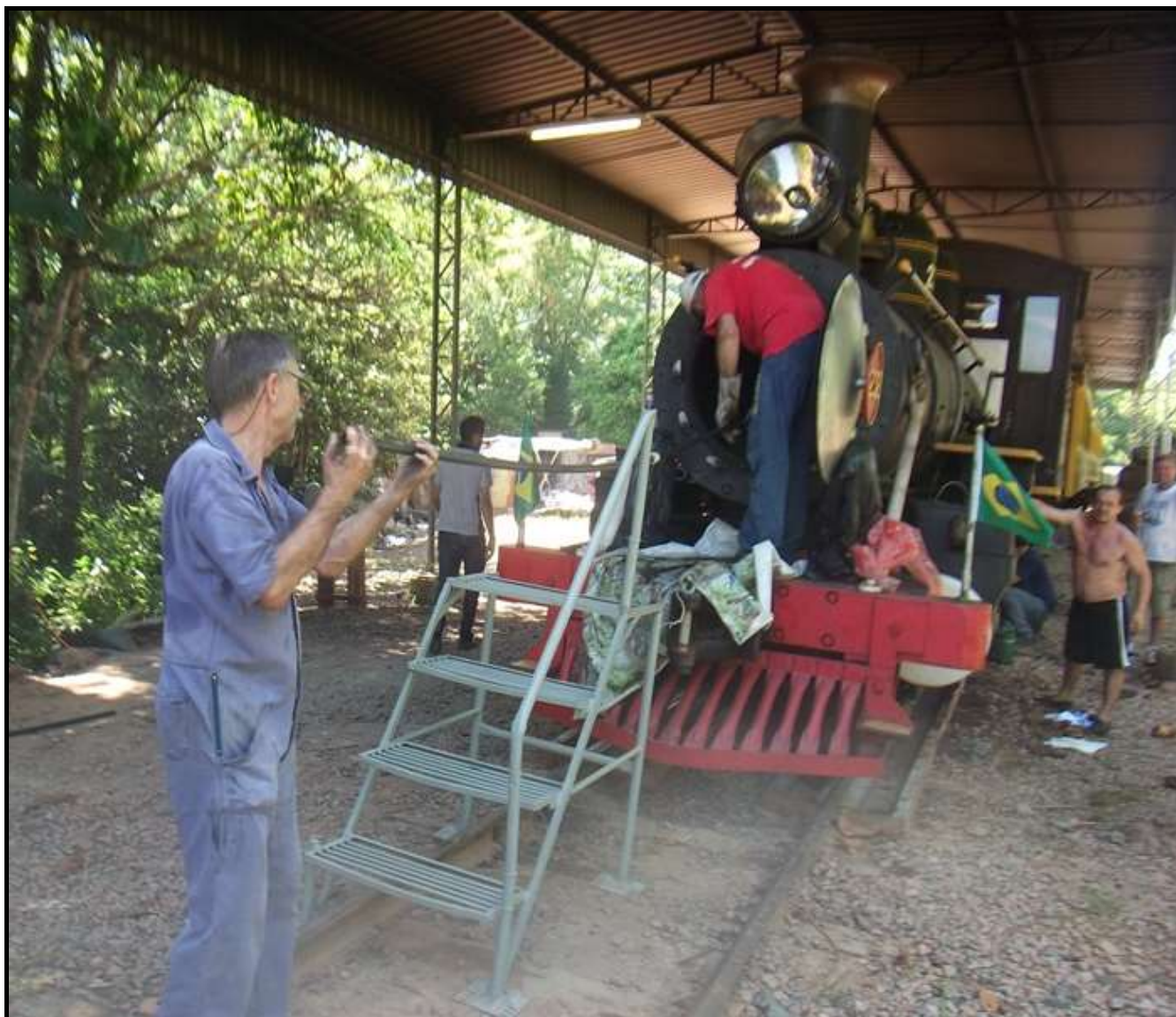
Além de uma criteriosa limpeza de tubos e da caixa de fumaça da locomotiva 232, também foram limpas as rodas de tração e do tender. Foto Luiz Carlos Henkels em 01/02/2014.
