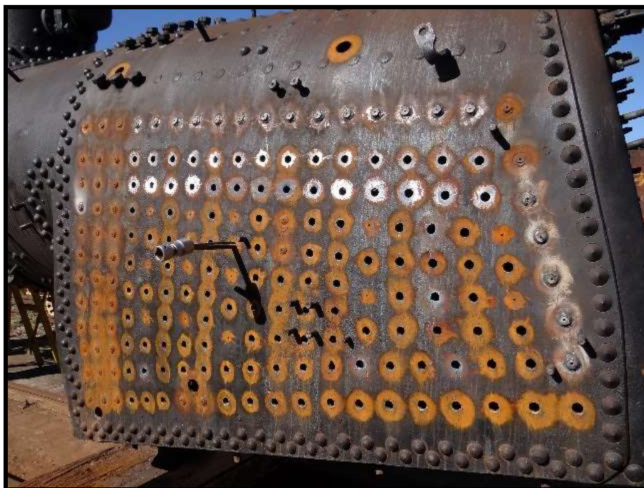
Aspecto da fornalha da 522, após remoção dos estais originais e já com alguns estais novos.
