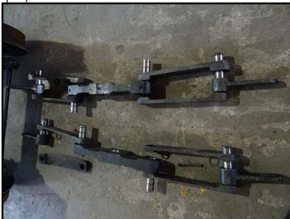
Braços da suspensão montados provisoriamente com novos pinos e buchas para a locomotiva 522.
