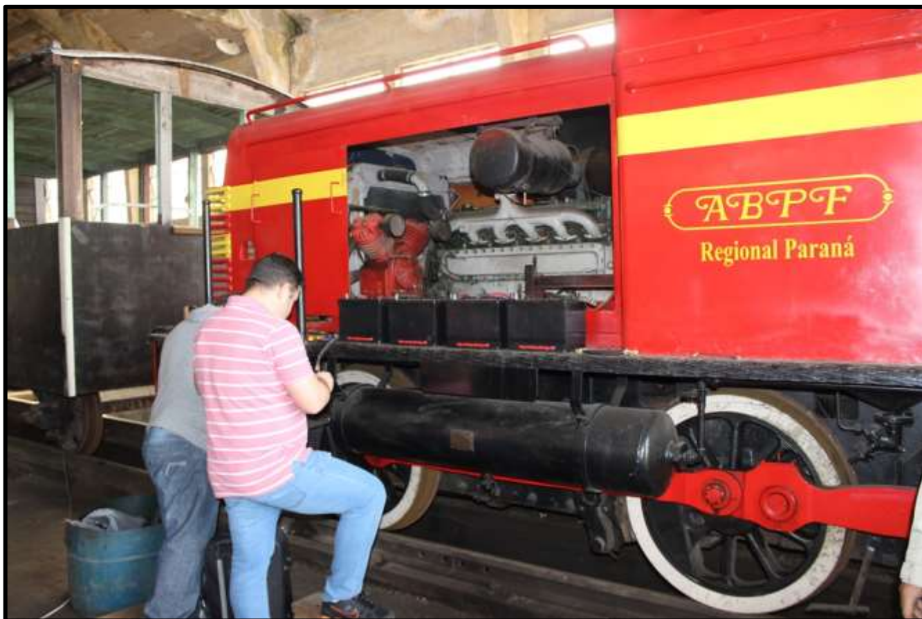
Troca das bateria da locomotiva francesa pela equipe da Baterias Cral, juntamente com o Sr. Willy.
