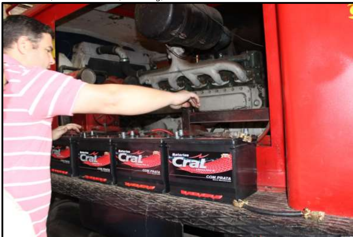
Troca das bateria da locomotiva francesa pela equipe da Baterias Cral.
