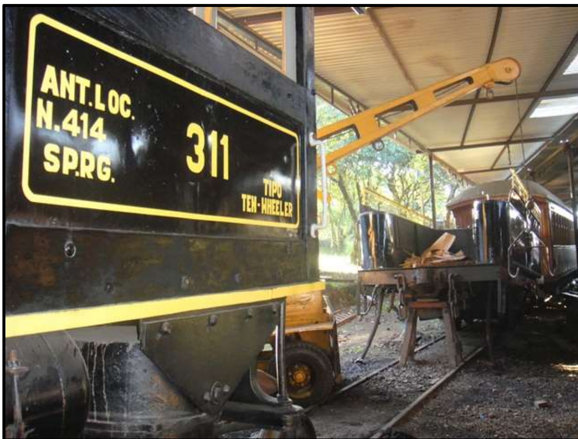
Tênder da locomotiva nº 311 já com o truque removido para os trabalhos de manutenção.
