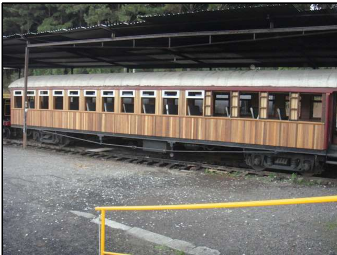
Carro C-01 na finalização da troca do madeiramento externo.
