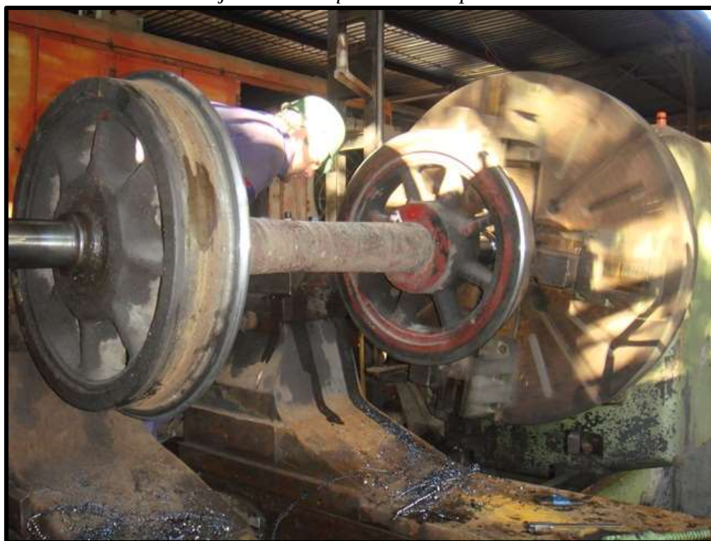
Rodeiro do tênder da locomotiva nº 311 no torno aguardando usinagem.
