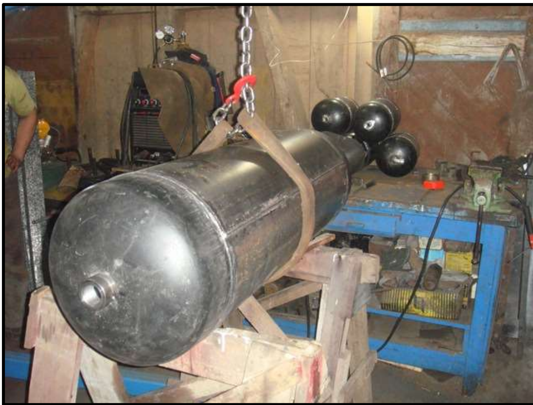
Montagem dos reservatórios de ar nas oficinas de Rio Negrinho.
