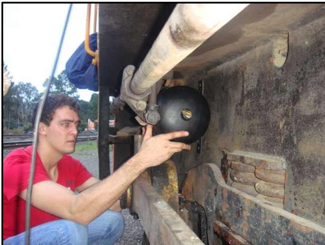
Eng. Marlon acertando a posição do reservatório de ar na locomotiva Bitruca.
