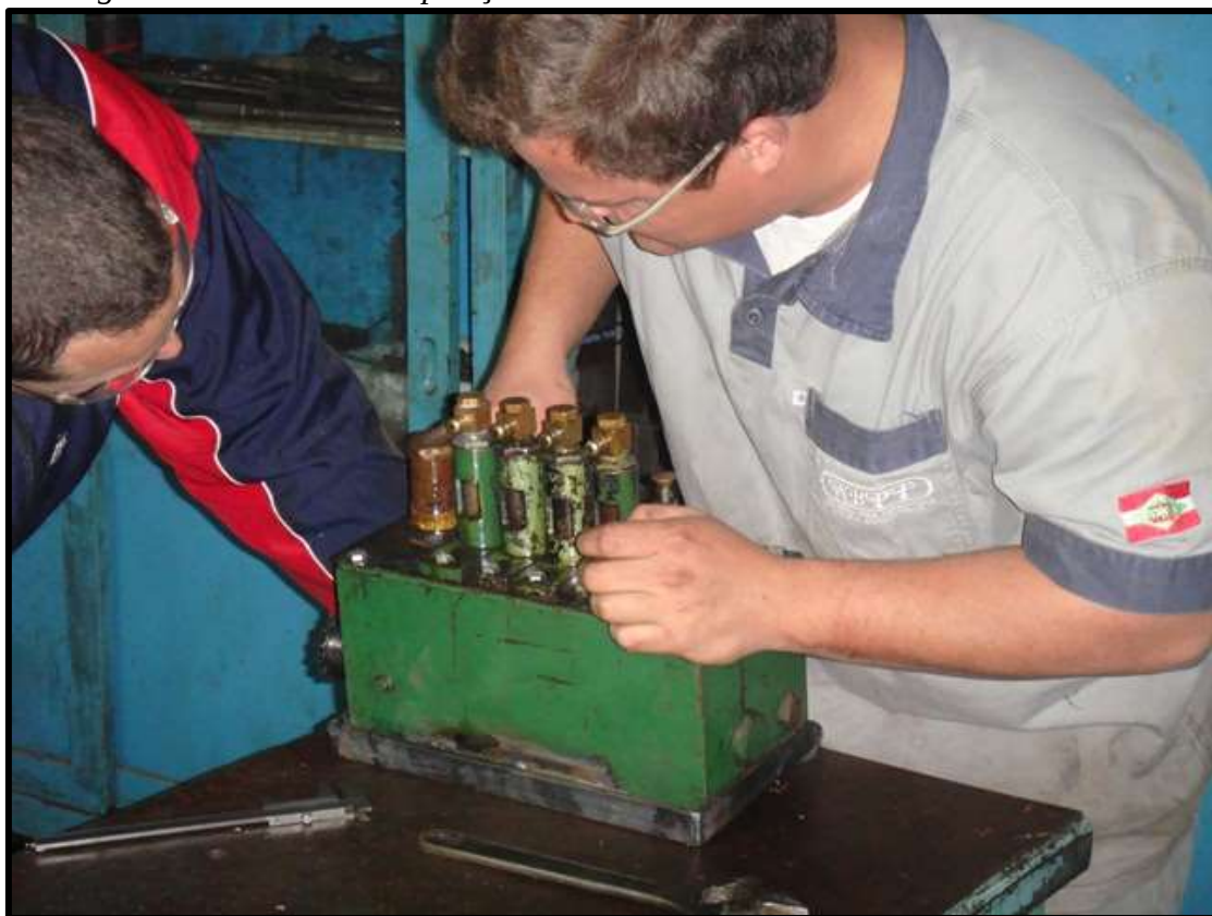
Eng. James e torneiro Maikon ajustando um dos aparelhos de lubrificação da locomotiva nº 204.
