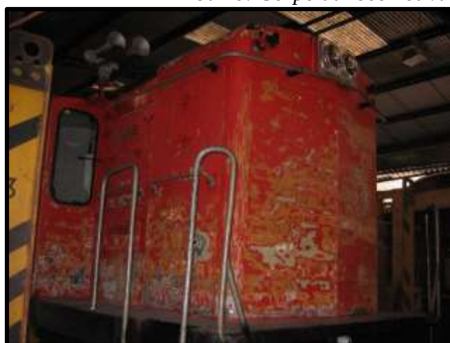
Abaixo: Corpo da locomotiva sendo preparado para pintura.
