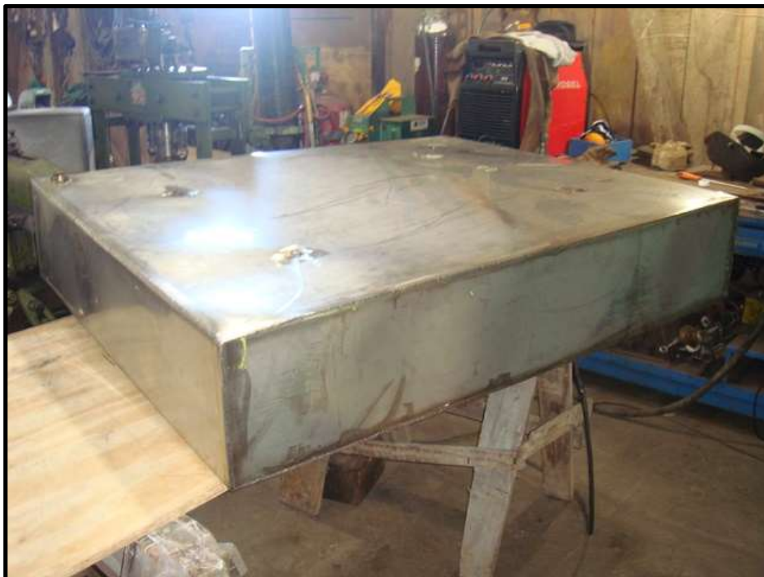
Uma das duas novas caixas d'água para o carro administrativo A-02.
