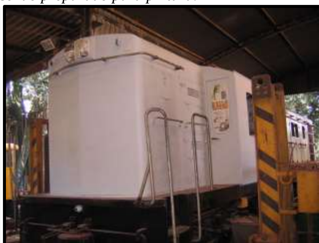
Abaixo: Corpo da locomotiva sendo preparado para pintura.
