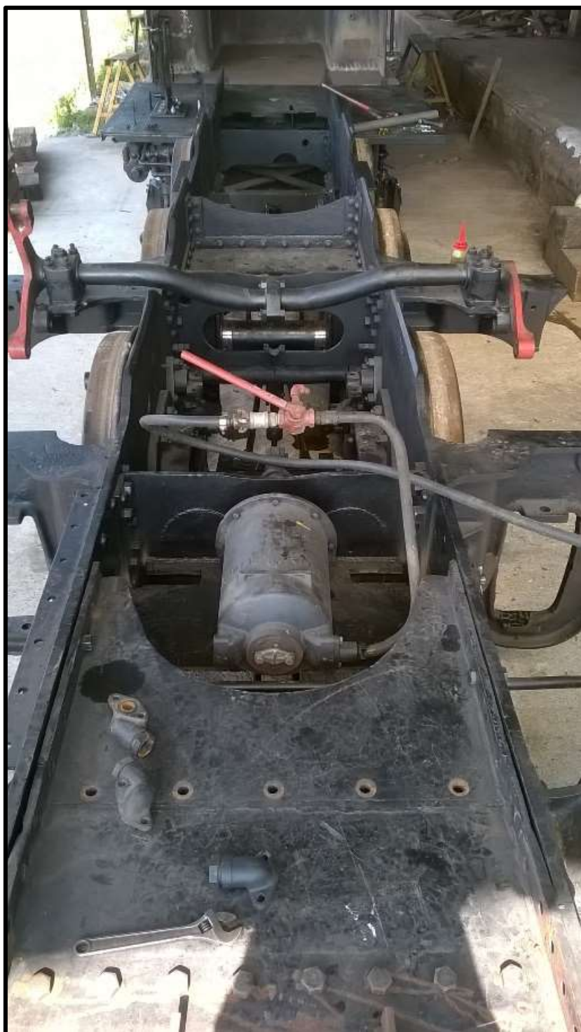
Longeirão da locomotiva 327 completamente montado.
