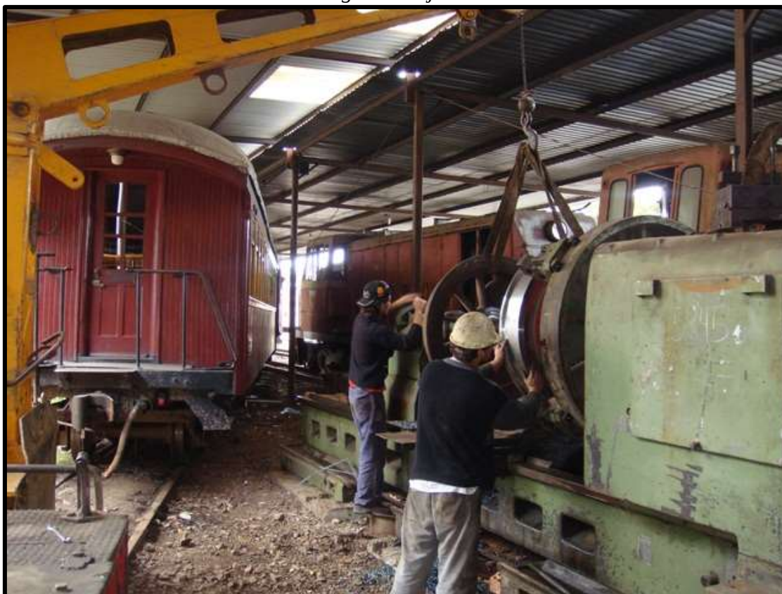
Rodeiro da Mogul nº 11 sendo centrado no torno por Maikon e Renan.
