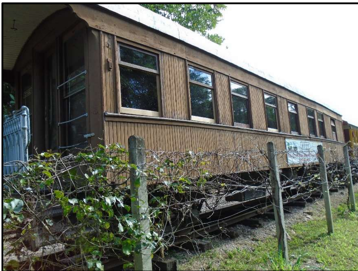
O carro AM 55 já com novas vidraças e caixilhos restaurados.
