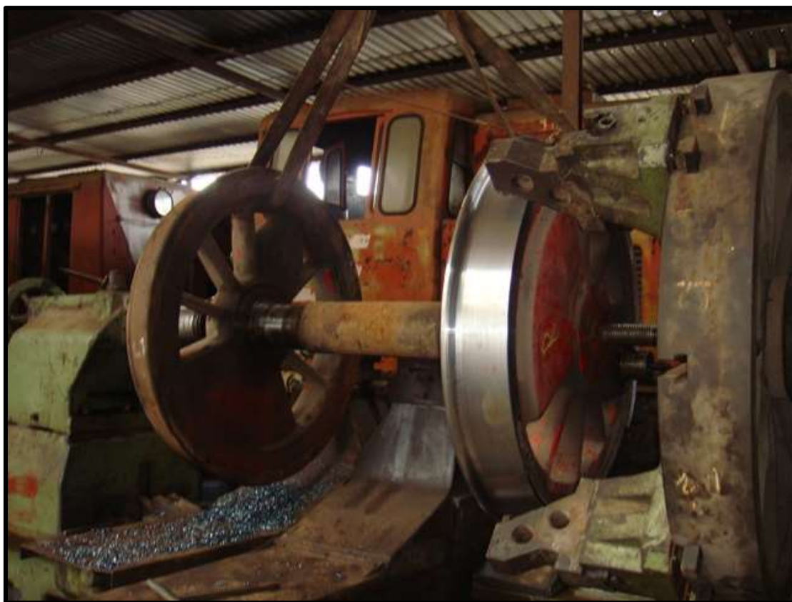
Rodeiro da locomotiva Mogul nº 11 já com um dos lados usinado.
