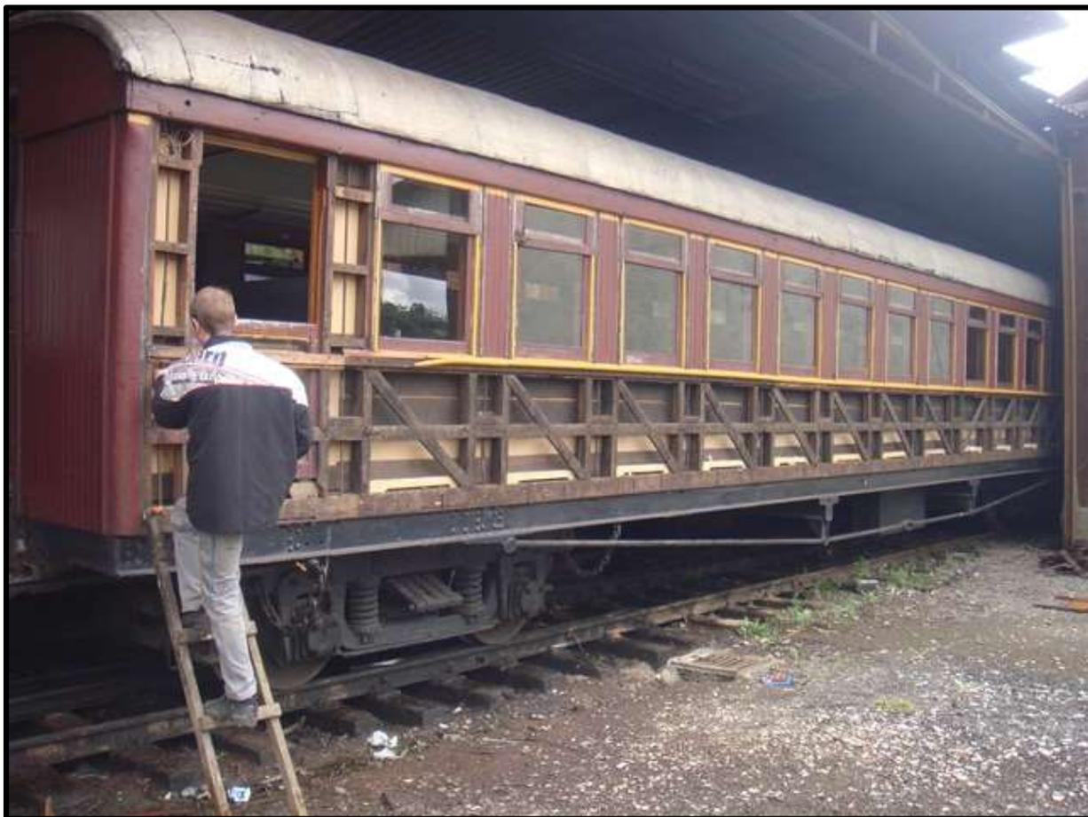
*Carro nº 01 da composição do trem da Serra do Mar sendo revisado após ser desmontado para restauração. Abaixo podemos ver suas janelas sendo recuperadas.*
