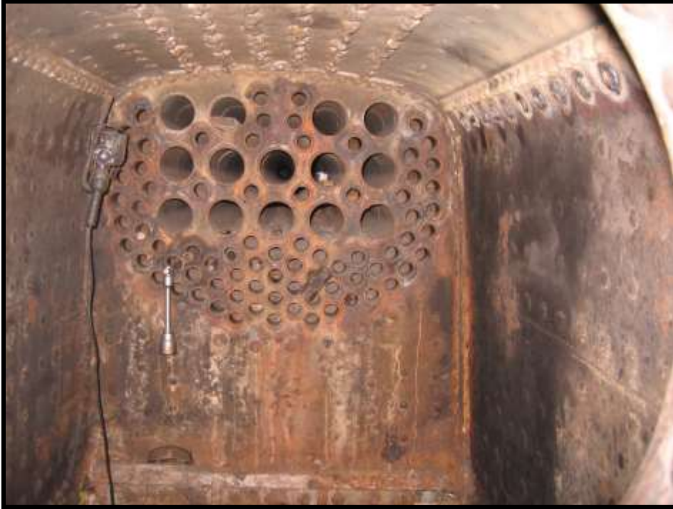
Acima: Fornalha da locomotiva 401 durante troca de tubos.
