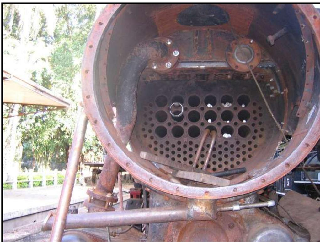
*Acima: Locomotiva 338 em restauração nas Oficinas de Carlos Gomes. O tubo grande no interior da caixa de fumaça é chamado de condutor de vapor, pois leva o vapor da caldeira ao cilindro.*
