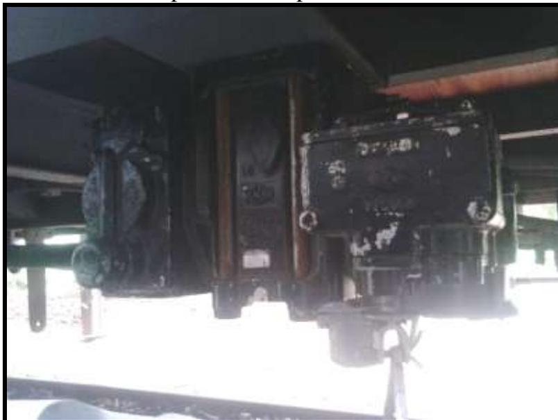
*Válvula de freio DB-60 instalada no carro CA-35. Foto: Rodrigo J. Cunha.*
