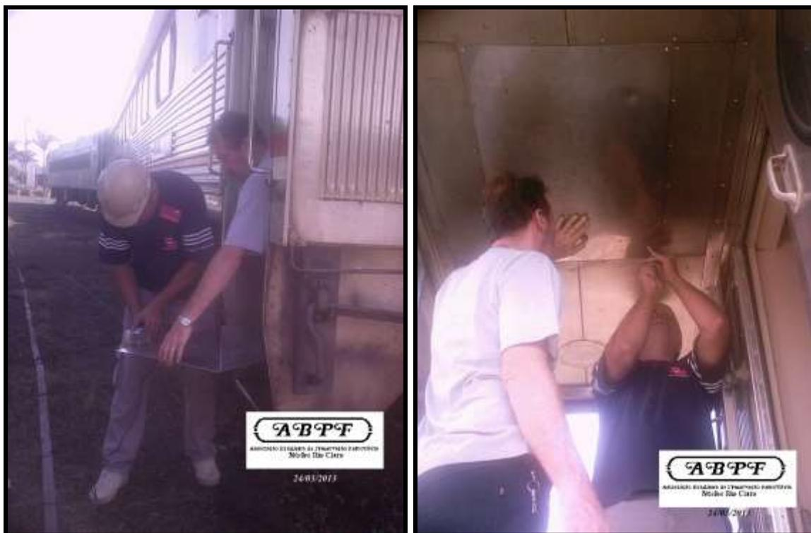
À esquerda: diretor Eder e associado Arnaldo dando os últimos ajustes para instalação da nova chapa de alumínio para o teto do carro. À direita: a chapa já instalada.
