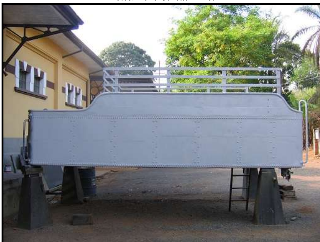
Acima: Interior do carro CA-18 em restauração nas oficinas de Carlos Gomes. Abaixo: Tênder da locomotiva 338 após demão de primer. Fotos: Hélio Gazetta Filho.
