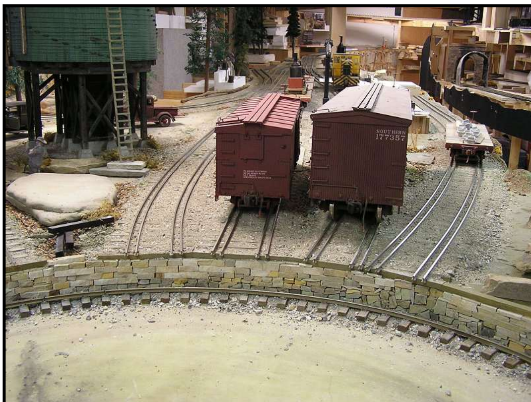
Maquete de Don Niday, onde o autor quis demonstrar a utilização de duas bitolas distintas em escala. É visível a diferença no porte dos vagões de acordo com a bitola.
