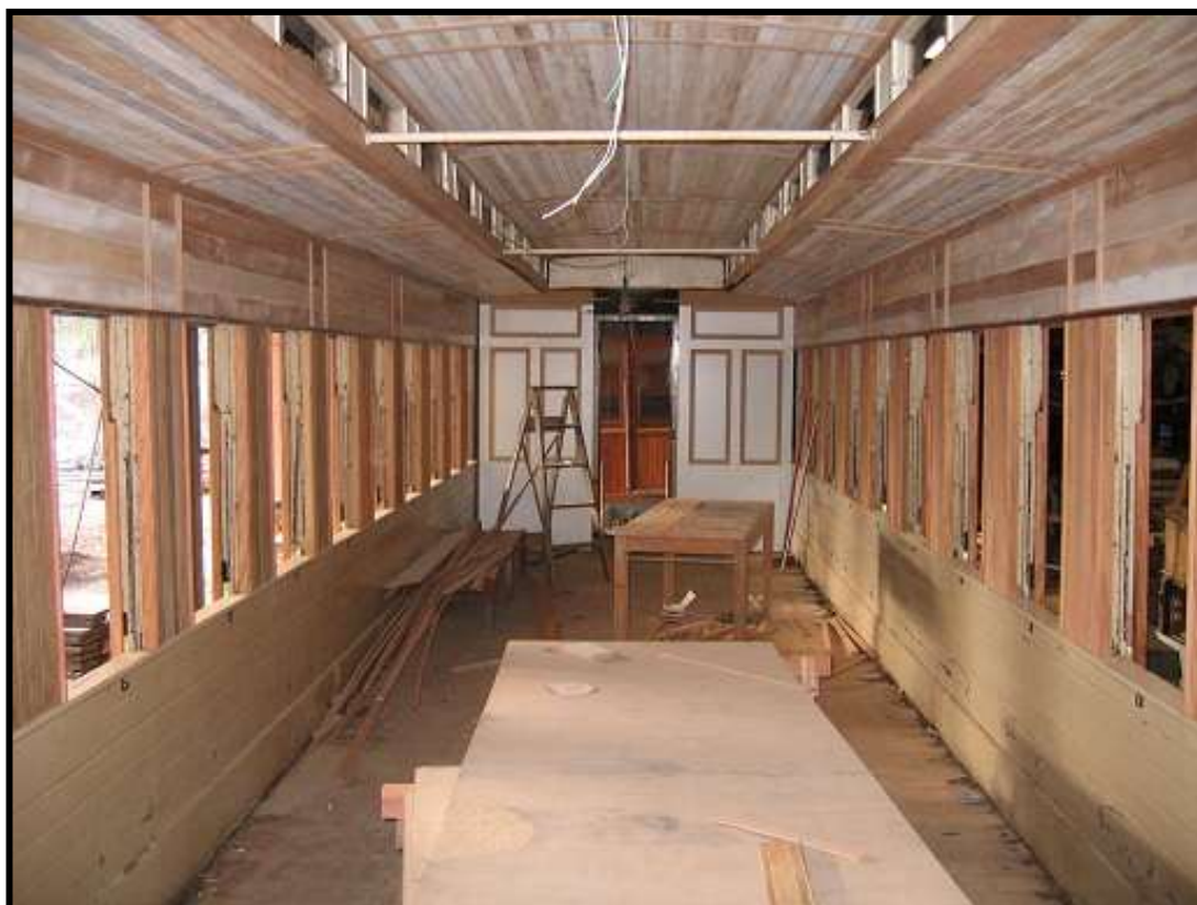
Acima: Interior do carro CA-18 em restauração nas oficinas de Carlos Gomes. Abaixo: Tênder da locomotiva 338 após demão de primer. Fotos: Hélio Gazetta Filho.
