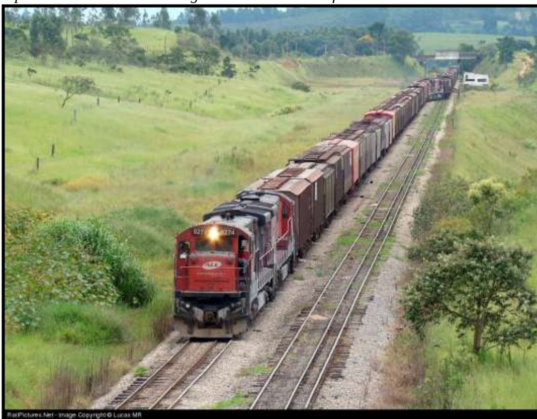
Trecho em bitola mista (1,00m por dentro e 1,60m por fora) no estado de São Paulo, operado pela ALL e pela FCA. Foto de Lucas MR.
