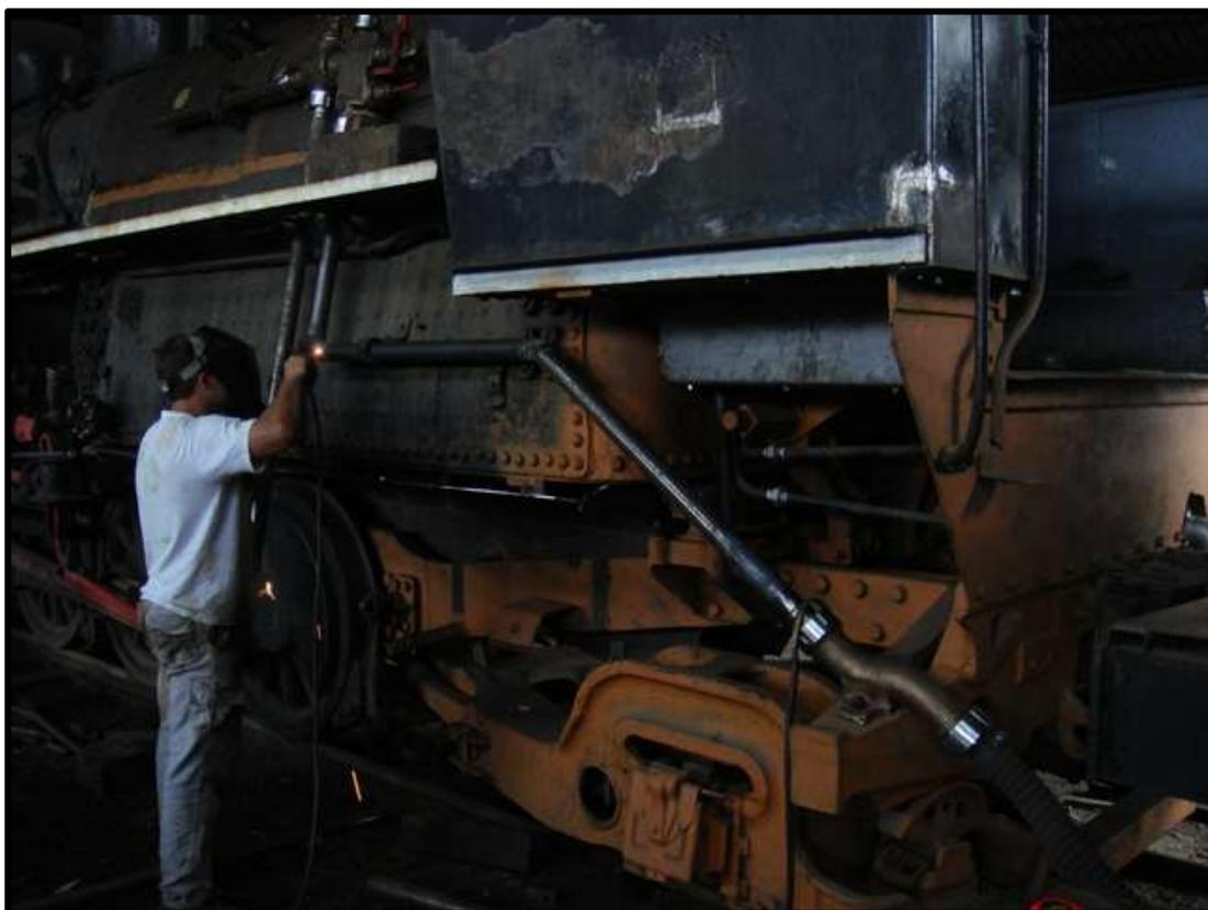
*Instalação do encanamento de água na locomotiva Mallet nº 204.*
