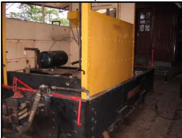
*Instalação de cilindro de ar comprimido e encanamento de ar para freios na locomotiva Brookville. Fotos: Hélio Gazetta Filho.*
