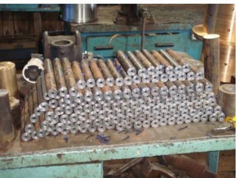
*Furação para estais na chapa lateral e Início da usinagem de centenas de estais*
