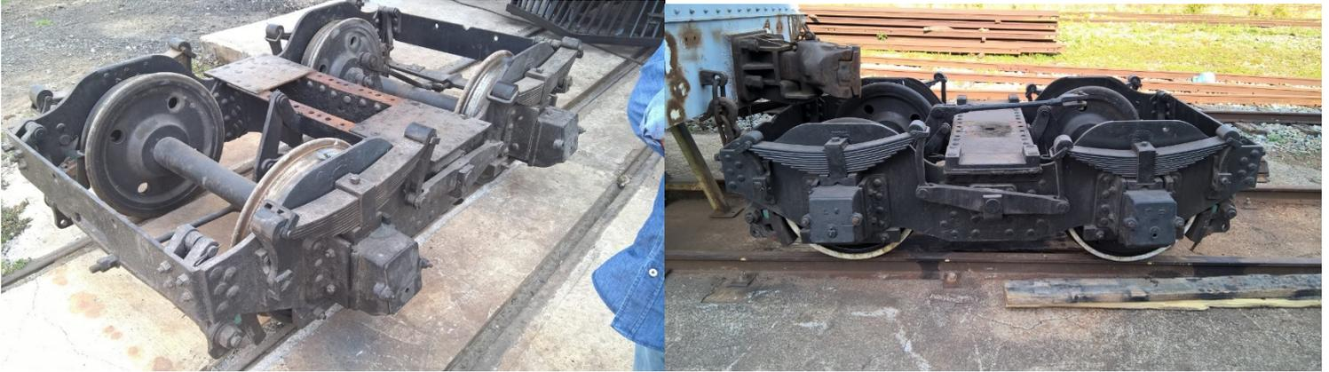
*Os truques do tender estão sendo desmontados e revisados, sendo substituídas as chapas que se encontravam deterioradas*
