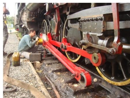
*A bucha completamente congelada entrando no puxavante e instalação na máquina com ajustes finais*
