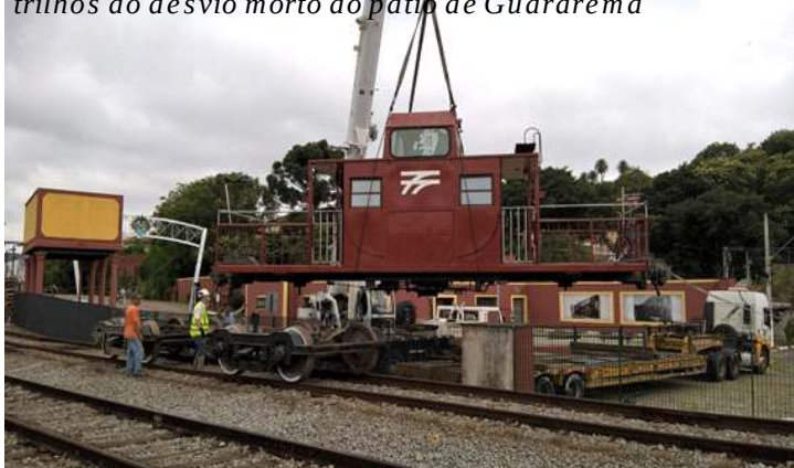
Os truques desceram primeiro e foram colocados nos trilhos do desvio morto do pátio de Guararema
