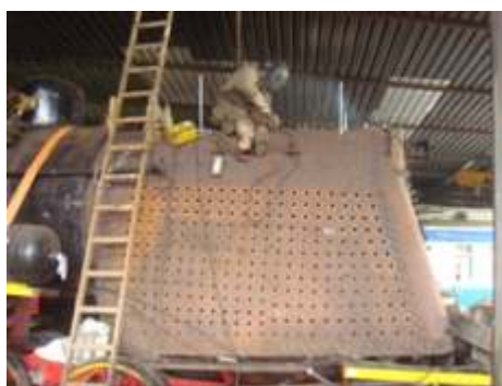
O início dos trabalhos de solda dos estais externos e da fixação da chapa do dedo da fornalha
