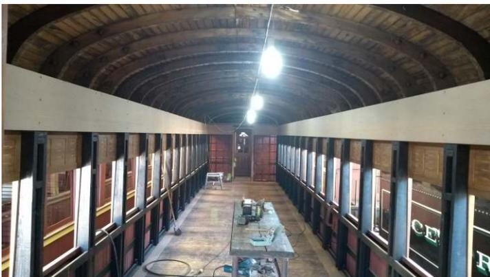
+ Aspecto interno do carro SD-02 em Dezembro de 2017: o novo revestimento começou a ser fabricado e instalado
