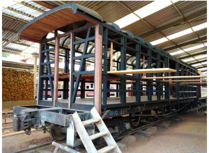
+ Aspecto do carro BC-32 no início dos trabalhos: o carro foi inteiramente desmontado e 100% das peças de madeira foram substituídas por novas devido ao estado de degradação
