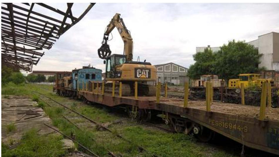
+ As pranchas da MRS com a carga de dormentes foram manobradas pela ABPF com uma das GE 44T de bitola métrica utilizando uma das Sentinel como "vagão madrinha"
