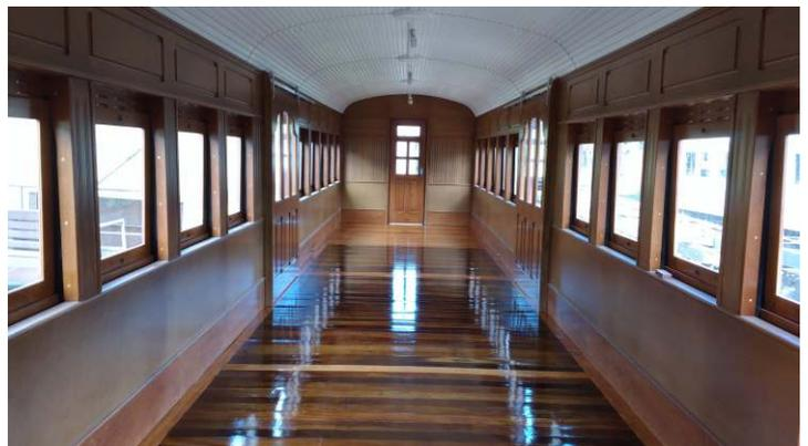
+ Aspecto interno do carro BC-32 em Dezembro de 2017: novo revestimento concluído, com sinteco aplicado no piso e forro do teto pintado de branco para melhor iluminação
