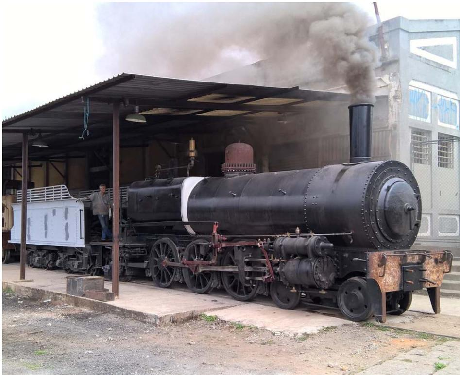
+ A 327 acessa no dia do teste de linha: várias voltas foram dadas pelo pátio afim de se verificar os componentes ,mecânicos da locomotiva bem como seu funcionamento
