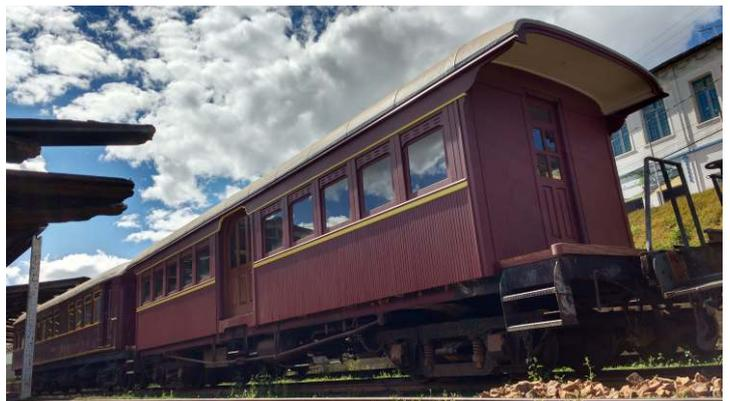
+ Aspecto externo do carro BC-32 em Dezembro de 2017: novo revestimento concluído, com pintura já aplicada, janelas, vidros e portas montados
