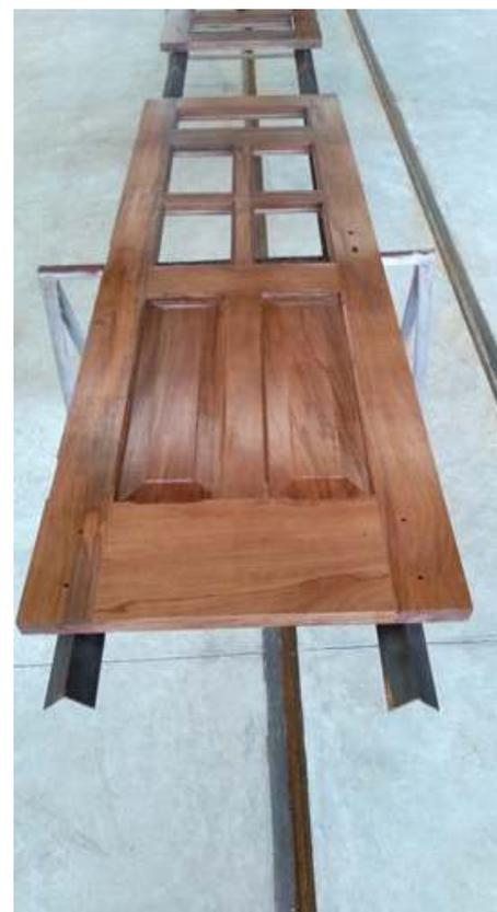
Novas portas foram confeccionadas: a direita pré-montada no carro para ajustes e a esquerda após receber acabamento
