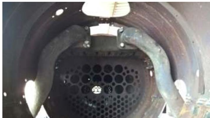
O condutor de vapor da locomotiva nº 522 após a revisão foi reinstalado na caldeira, com montagem do cabeçote do superaquecedor e dos condutores para os cilindros
