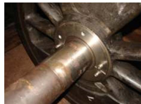
*Rodeiro da nº 204 com o encosto da encubação retirado e já com a instalação da peça nova*
