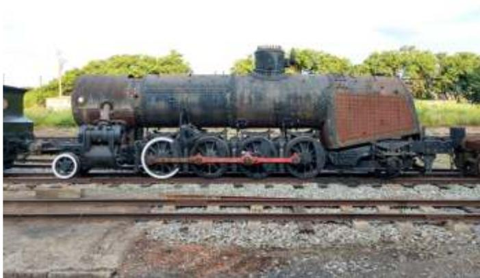
A locomotiva 522 foi rebocada várias vezes pelo pátio afim de se verificar o seu comportamento na linha, observando-se os ajustes da suspensão, caixas das rodas e cubação
