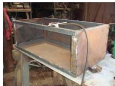
*Nova caixa de baterias que será instalado a Locomotiva Mallet*
