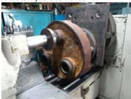
*A complicada contagem de um dispositivo que centralizasse esta peça para usinagem da rosca desgastada que segura o apito*
