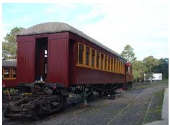
*Confecção de uma nova caixa da água e revisão da parte rodante no carro passageiro C-04*
