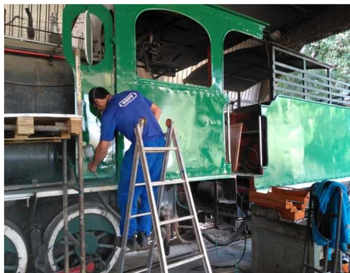
A locomotiva 505 que aguarda nova peça (válvula) do regulador de vapor, a mesma já está quase pronta, inteiramente construída em nossas oficinas. A original é fundida e está sendo feita toda usinada e com algumas soldas. Está sendo repintada e quase concluída a locomotiva 215, em uso esporádico em Anhumas. A pintura está sendo feita no próprio pátio da estação.
