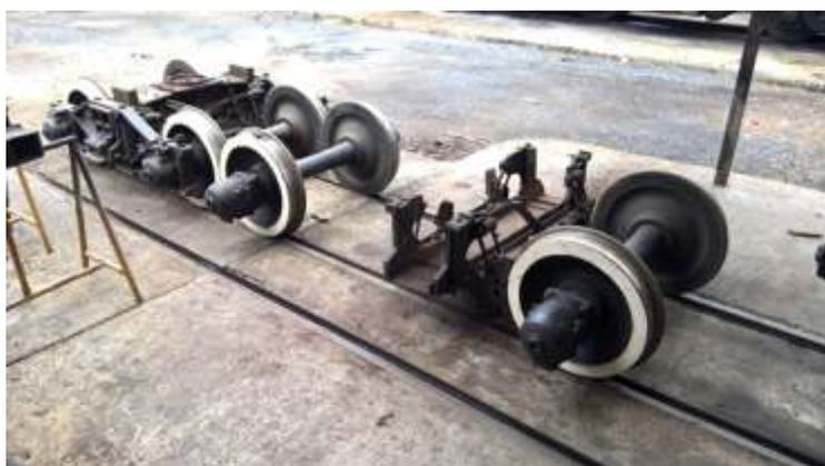
*Um dos truques inteiramente desmontado para manutenção*
