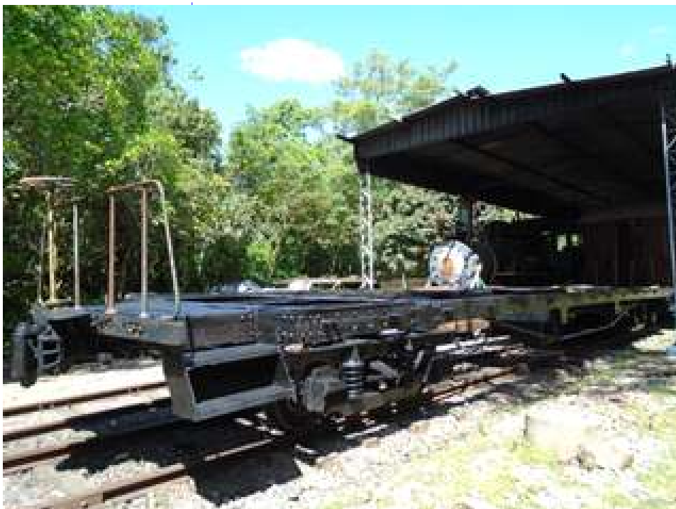
Ex carro P01 recebeu pintura nova no chassis e truques. Deverá ser convertido em vagão prancha.
