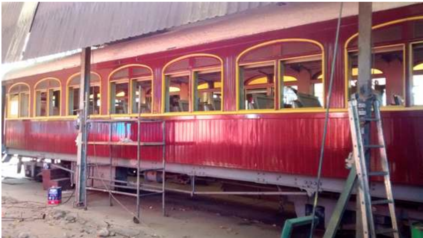
Repintura da caixa do carro CA-25
