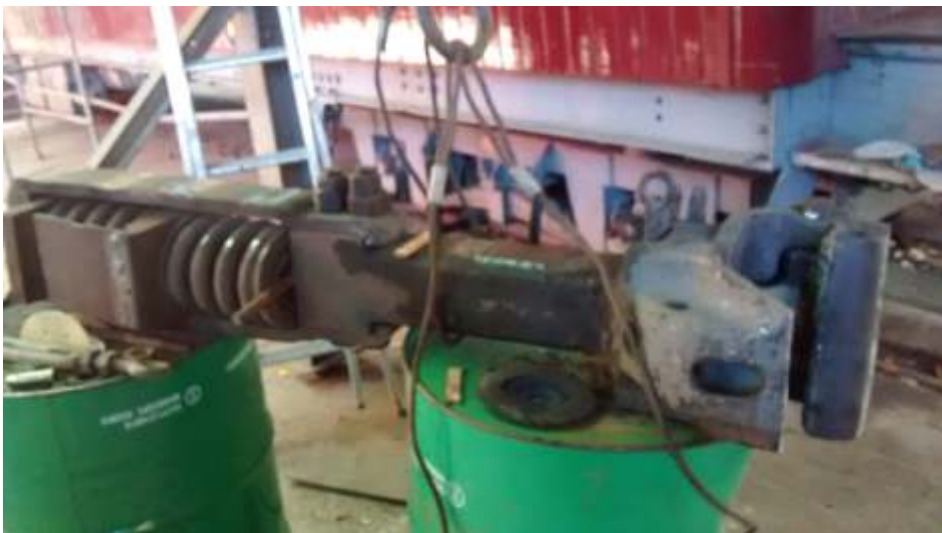
Reforma dos engates do carro CA-25
