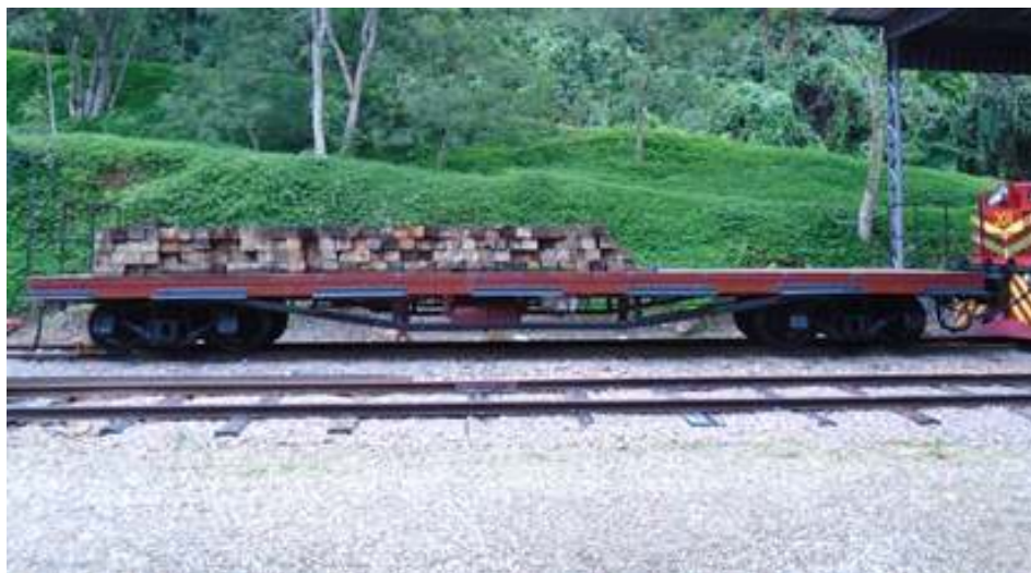
Vagão prancha com nova pintura nos truques e chassi
