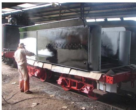
*Recebimento do tanque da água do tender, após jateamento e pintura*
