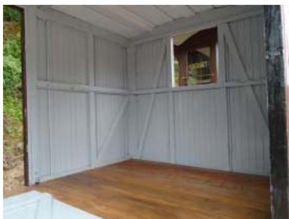
*Interior do vagão CAP já com a pintura interna finalizada e assoalho lixado*
