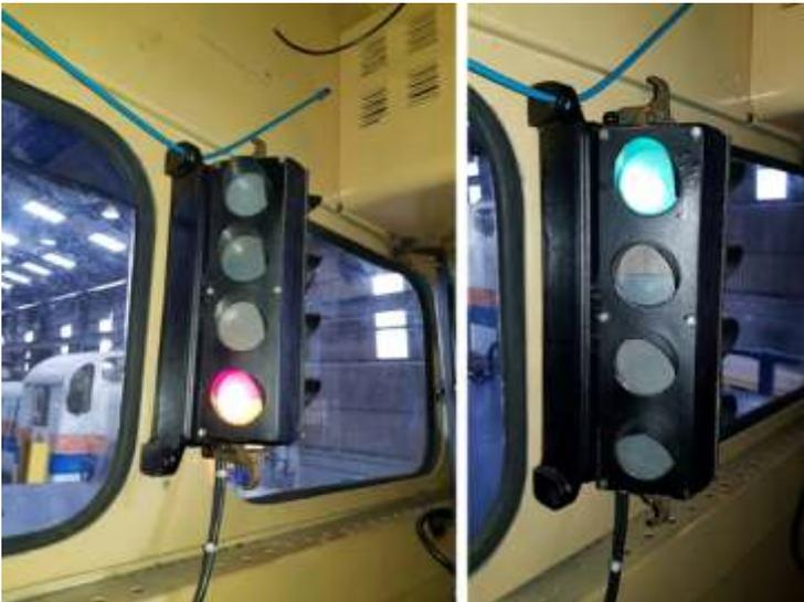
*O cab-signal já operacional durante os testes do sistema ATC*
