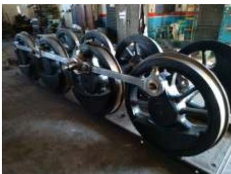
*Ensaio de montagem já com as novas buchas instaladas nas braçagens*
