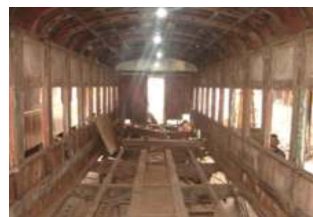
Os trabalhos na recuperação do chassi do carro passageiro PC -58
