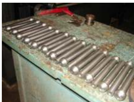
Os trabalhos de revisão da Mallet com a troca de todos os estais de bola na parte frontal
