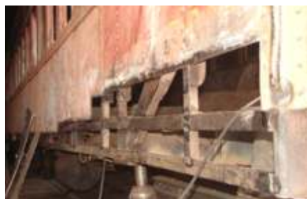
Os reparos das partes laterais do carro passageiro PC - 58
