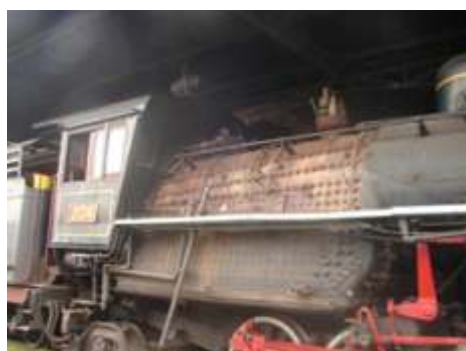
Os trabalhos de revisão da Mallet com a troca de todos os estais de bola na parte frontal
