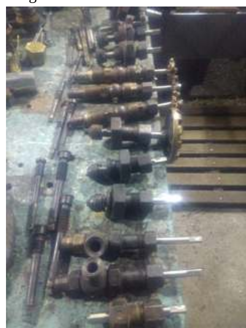
Ajustes e revisão de todos os registros da locomotiva Mallet
