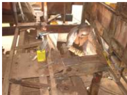
Os trabalhos na recuperação do chassi do carro passageiro PC -58
