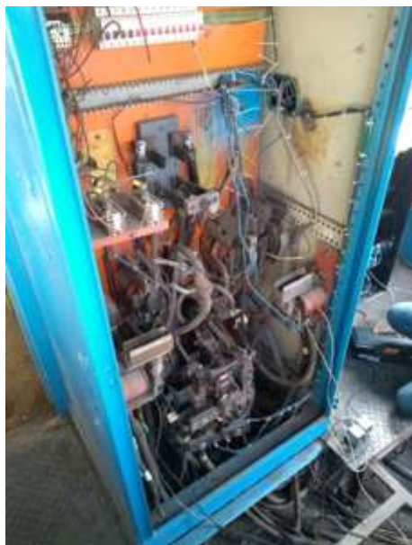
Antes e depois do armário elétrico da locomotiva: totalmente revisado e organizado com substituição dos equipamentos e cabeamentos.
