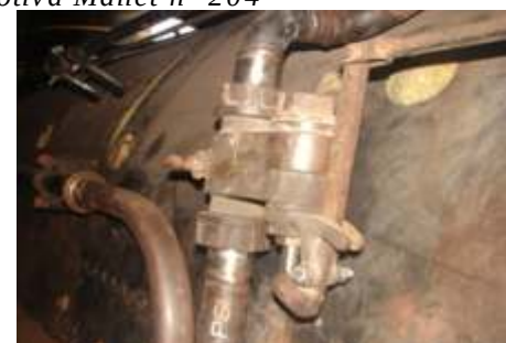
Novo sistema de injetoras semelhantes aos usados nas locomotivas Santa Fé são instaladas na locomotiva Mallet
