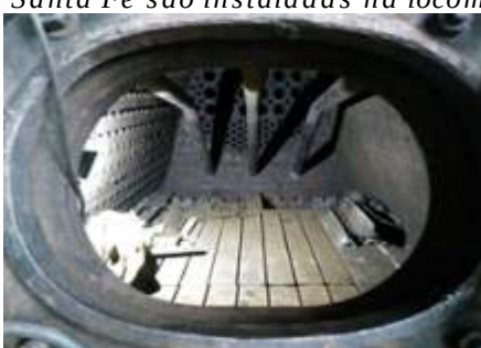
Os três novos tubos instalados na fornalha da Mallet e os tijolos refratários saindo da forma
