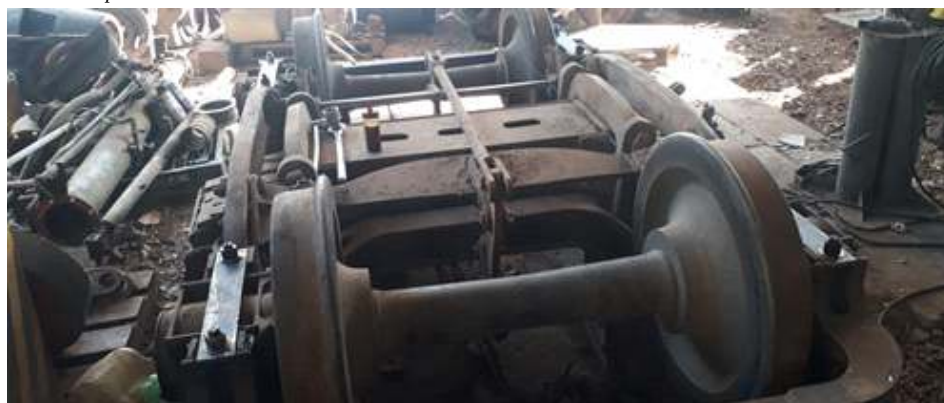
Um dos truques já montado e agora preparado para limpeza e pintura
