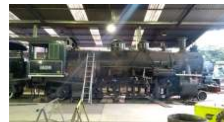
O revestimento da caldeira já reinstalado.
