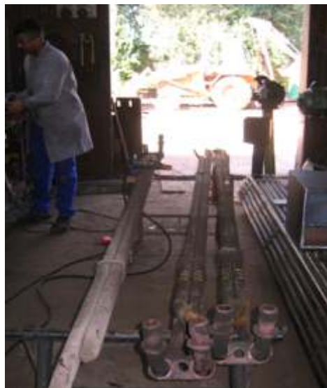
Reparos da serpentina da locomotiva a vapor 338
