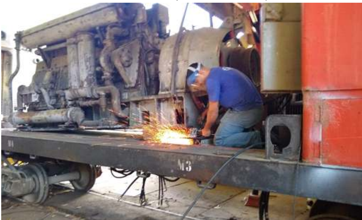
Instalação do motor diesel no local definitivo. Foto de Norberto Tomassoni.
