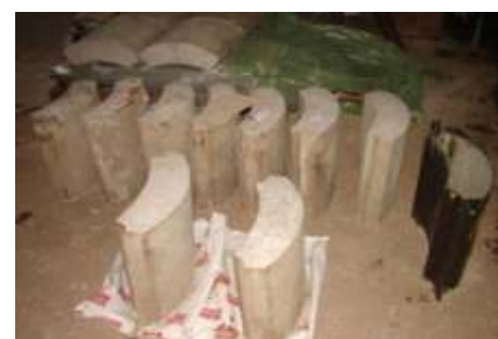
Os três novos tubos instalados na fornalha da Mallet e os tijolos refratários saindo da forma
