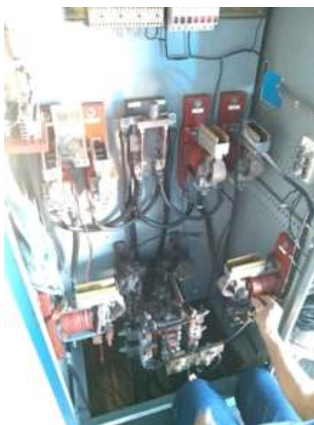
Antes e depois do armário elétrico da locomotiva: totalmente revisado e organizado com substituição dos equipamentos e cabeamentos.
