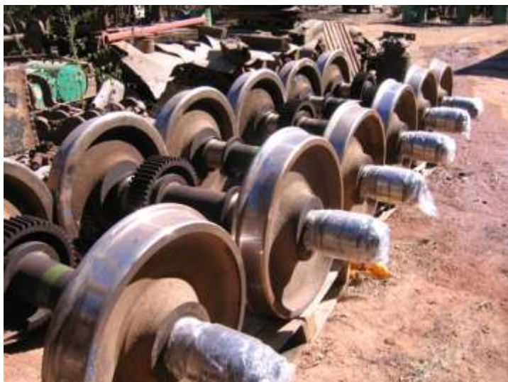
Rodeiros reparados da locomotiva GE 3128
