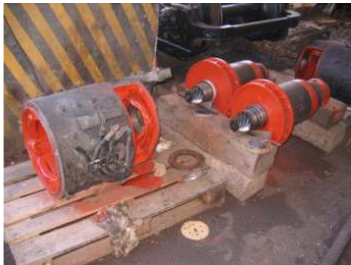
Motores de tração em reforma e revisão.
