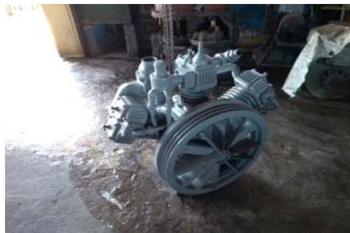
O compressor da GE já recuperado e pintado, pronto para ser reinstalado na locomotiva
