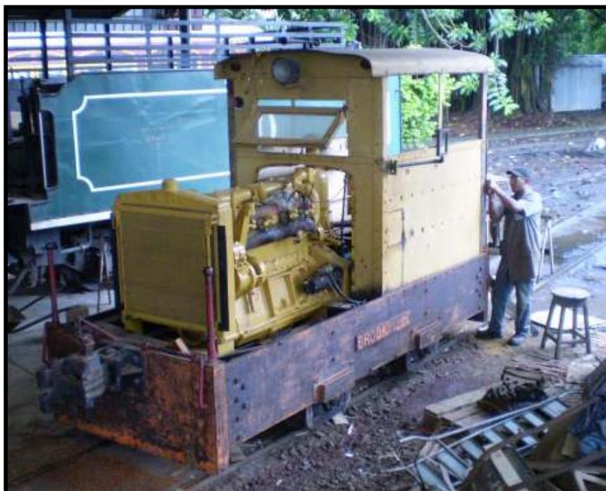
Locomotiva Brookville com o motor diesel recém reformado.
