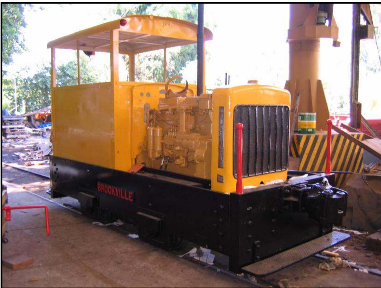
Locomotiva Brookville vista com o motor diesel recém reformado e nova pintura. Foto: Hélio Gazetta Filho em fevereiro de 2009.
