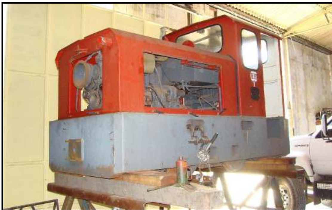
Locomotiva O&K sendo adaptada para bitola métrica nas Oficinas de Cruzeiro da Regional Sul de Minas. Foto: Felipe Sanches.
