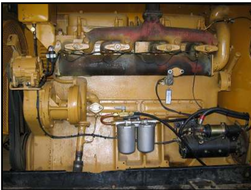
Vista do motor da locomotiva Brookville. Foto: Hélio Gazetta Filho em maio de 2009.
