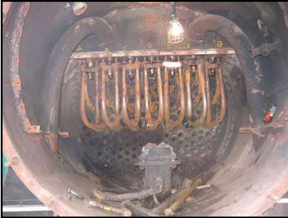
Acima: Interior da caldeira da locomotiva 505. Em destaque as serpentinas do superaquecedor. Abaixo: Interior do carro Budd CA-560 em reforma nas Oficinas de Carlos Gomes. Fotos: Hélio Gazetta Filho em setembro de 2009.
