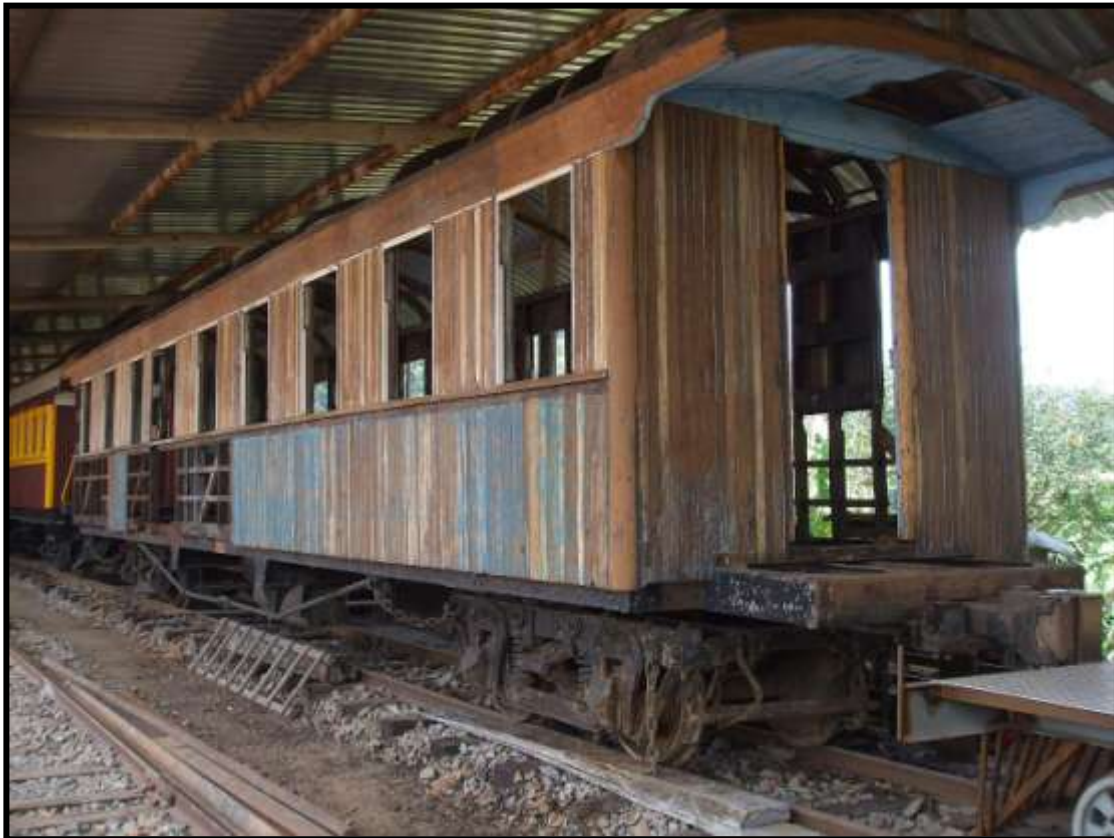
Aspecto do carro P 02 em início de restauração. Praticamente todo o teto, assoalho e 50% da lateral terão que ser reconstruídos. Foto: Luiz Carlos Henkels em 8/11/2009.
