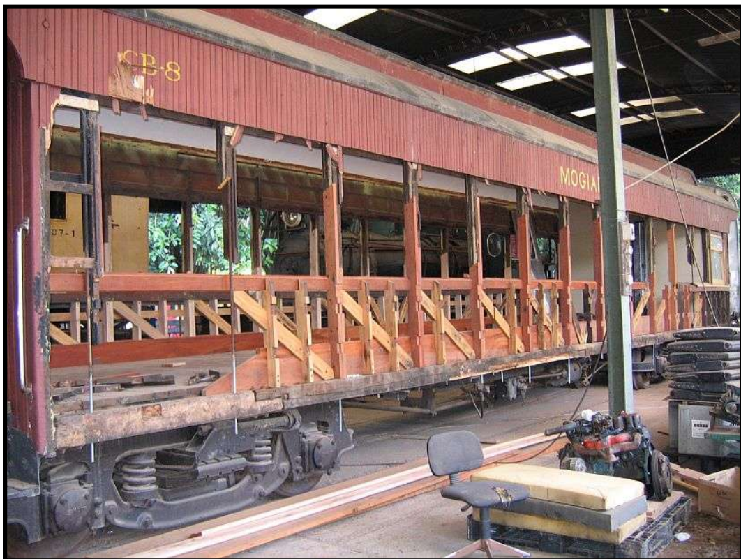
Carro CB-8 da Mogiana em reforma nas Oficinas de Carlos Gomes. A nova madeira instalada no carro é a de cor clara. Fotos: Hélio Gazetta Filho.
