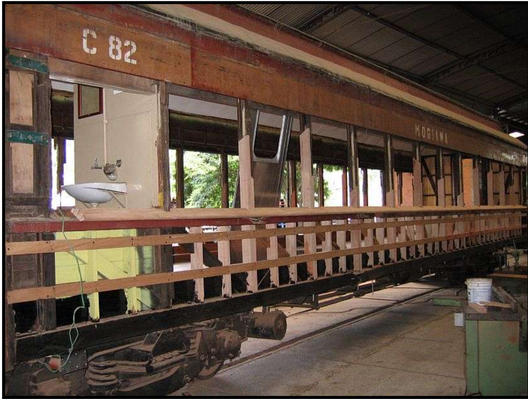
Carro CB-8 da Mogiana em reforma nas Oficinas de Carlos Gomes. A nova madeira instalada no carro é a de cor clara. Fotos: Hélio Gazetta Filho.
